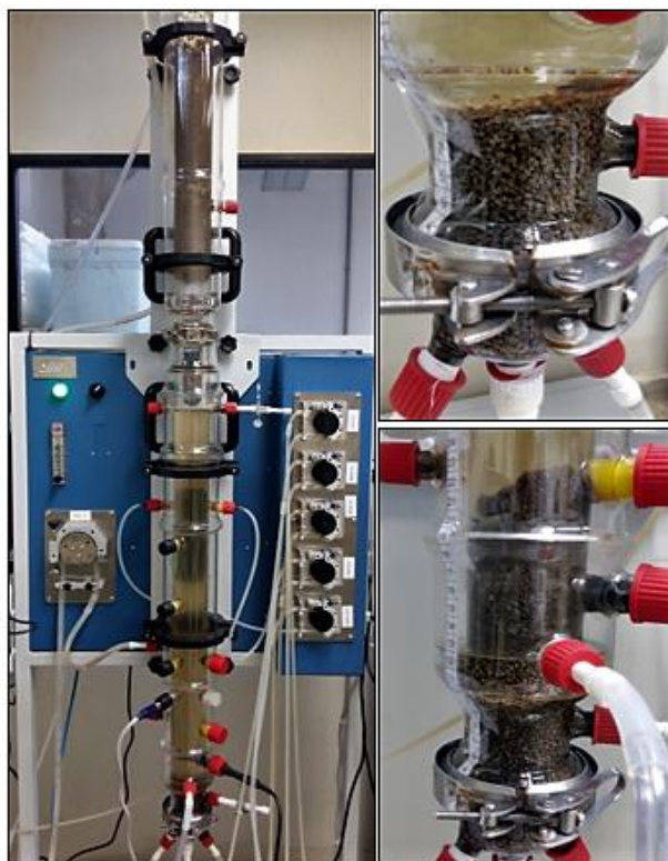
Figura 31: Grânulos aderidos à parede do reator devido à formação de espuma durante o período de aeração com a adição de 5% de lixiviado no afluente.
