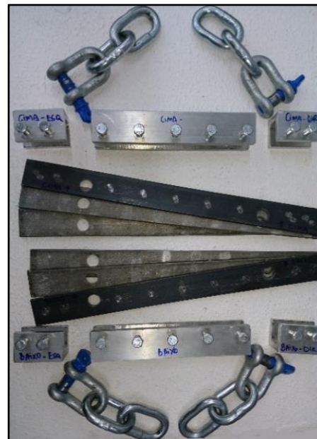
Figura 1. Aparato para tração em geossintético (conjunto de garras em bloco compressivo, manilha e correntes).
