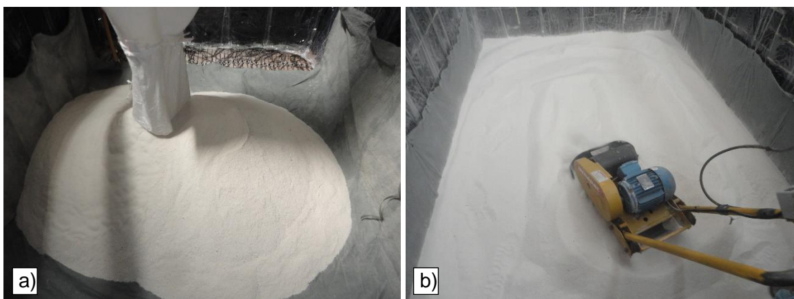
Figura 3.12. a) Lançamento da camada a ser compactada; b) distribuição do solo antes da compactação, deixando sempre um pouco mais de solo ao centro;
