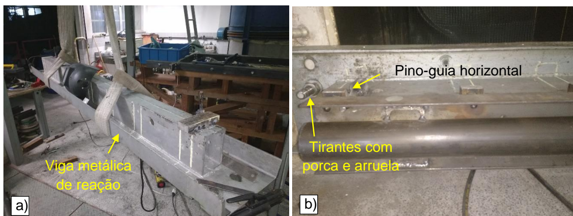
Figura 3.7 Detalhes da montagem do modelo físico: a) viga metálica de reação ao sistema de pré-carregamento; b) detalhe da fixação do sistema.
