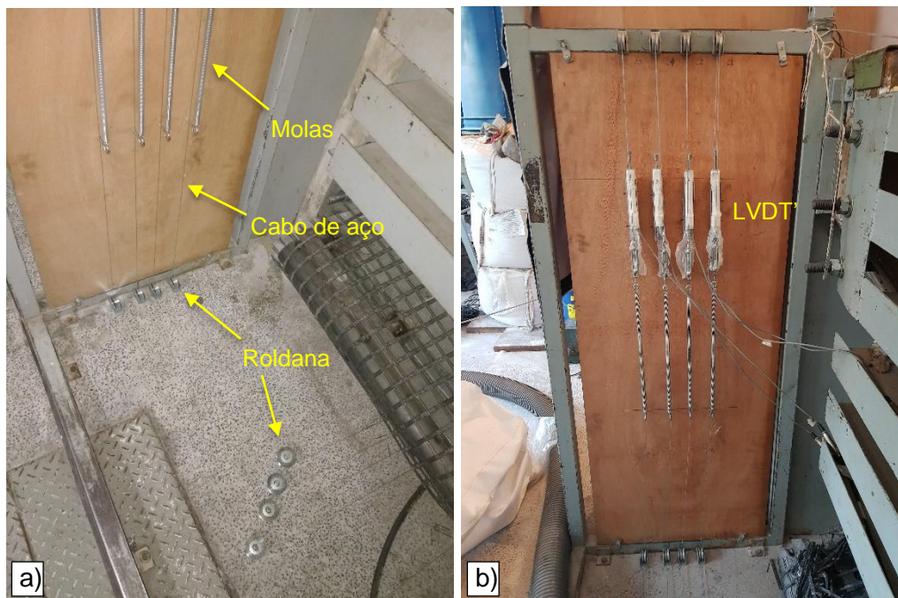
Figura 3.20. Aparato medidor de deslocamentos da plataforma hidráulica: a) detalhes das roldanas e molas que guiam e tencionam o cabo de aço; b) detalhe dos transdutores de deslocamento, ligados a cada macaco hidráulico.
