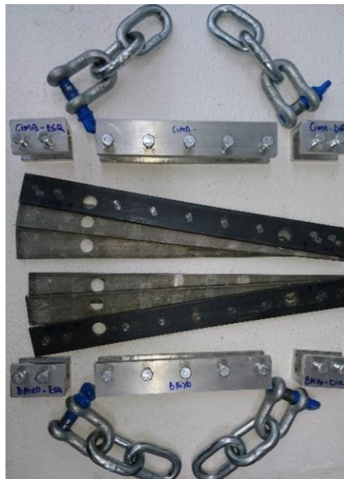
Figura 3.25. Aparato para tração em geossintético (conjunto de garras em bloco compressivo, manilha e correntes)
