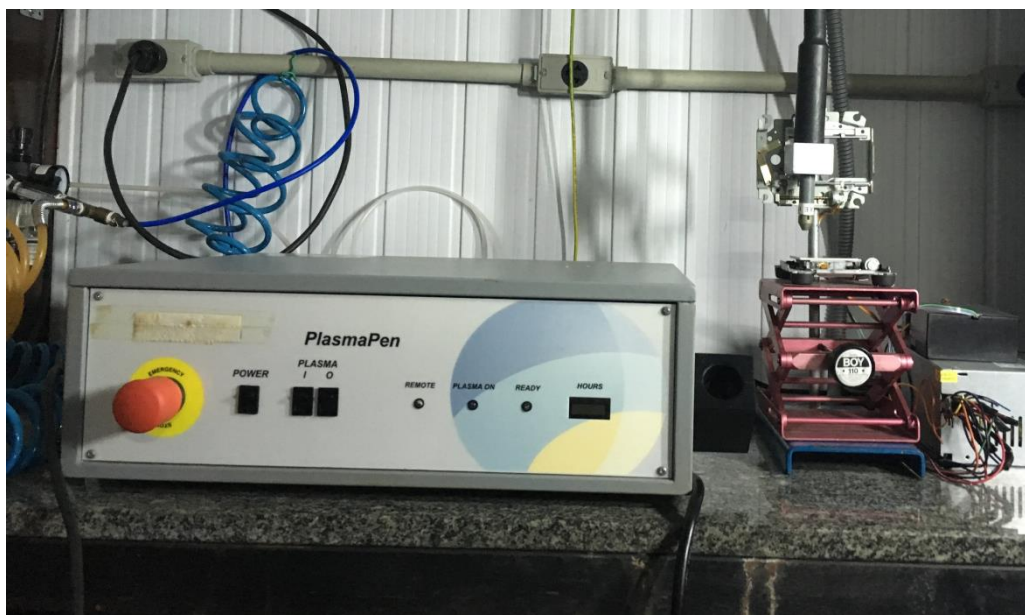
Figura 15: Sistema de plasma atmosférico PlasmaPen, onde foi realizado o tratamento das amostras de óxido de grafeno em solução.
