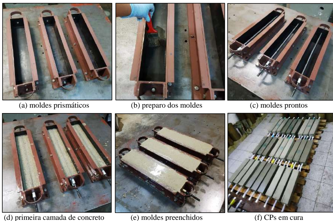
Figura 4.10 – Produção dos elementos estruturais
