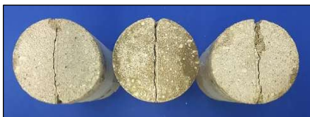
Figura 3.8 – Amostra do tipo de ruptura dos concretos no ensaio de resistência à tração
