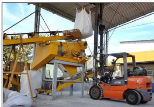
(a) lançamento do material no peneirador
