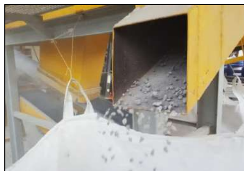
(b) saída lateral do peneirador
