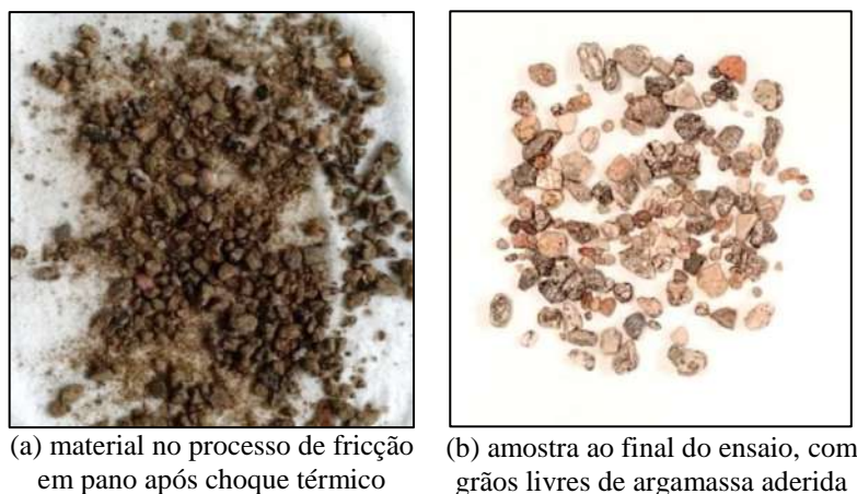
Figura 2.8 - Ensaio de teor argamassa aderida
