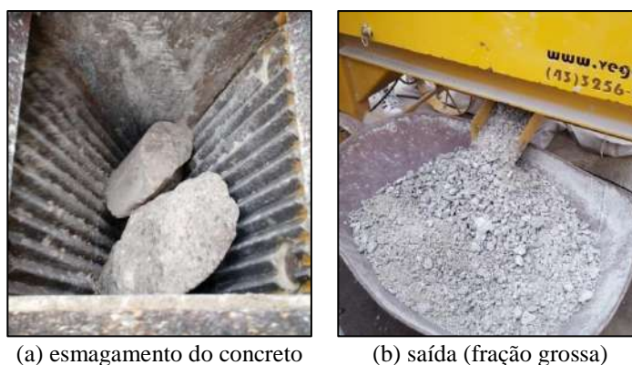
Figura 2.3 – Etapas da britagem dos resíduos
