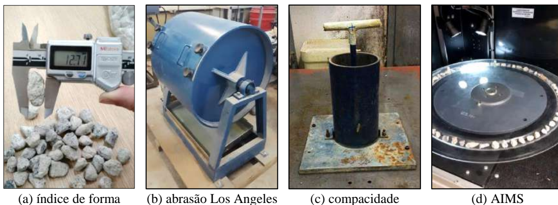
Figura 2.7 – Alguns métodos de ensaio dos agregados graúdos
