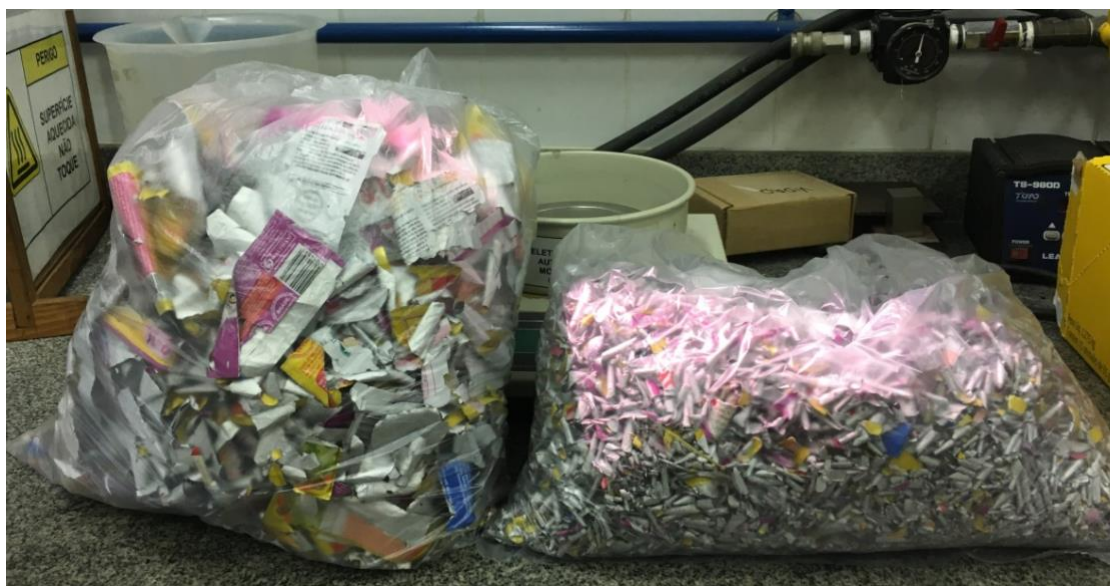
Figura 14 – Comparação entre um saco de material moído e outro de material aglutinado, contendo o mesmo peso em cada. Fonte: Fotografia realizada por Bruna Dalmacio, 2019.
