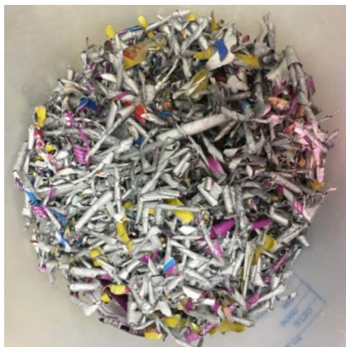
Figura 13 – a) Fragmentos do material aglutinado no equipamento aglutinador após passar pelo moinho e b) Fragmentos do material aglutinado acondicionado em saco transparente. Fonte: Fotografias realizadas por Bruna Dalmacio, 2019.
