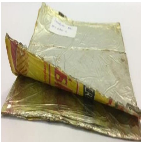
Figura 15 – Placa fabricada a partir do processo 2, à temperatura de 240°C, apresentando delaminação e pouca aderência entre as camadas. Fonte: Fotografia realizada por Bruna Dalmacio, 2019.
