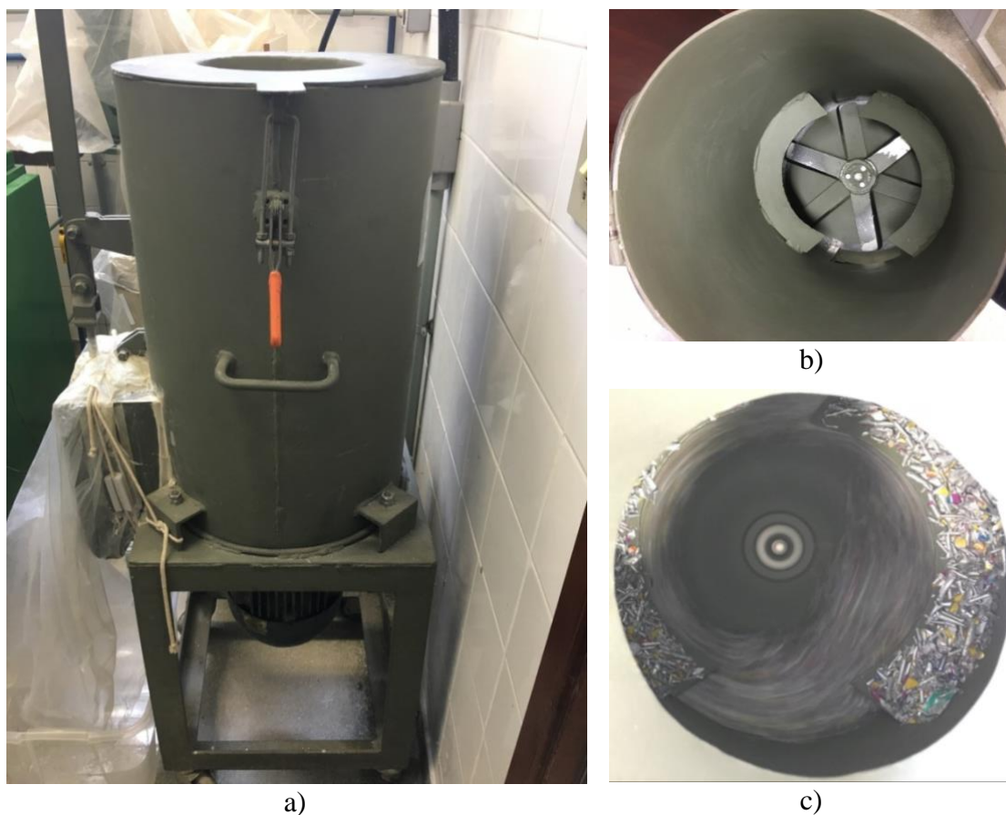
Figura 6 – Fotografias de a) Vista geral do equipamento aglutinador utilizado para aglutinar as embalagens moídas; b) Vista dos rotores do equipamento e c) Vista do material sendo aglutinado dentro do equipamento. Fonte: Fotografias realizadas por Bruna Dalmacio, 2019.
