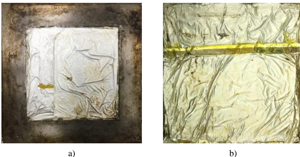
Figura 17 – a) Placa prensada a partir de duas placas confeccionadas com embalagem inteira pós-consumo invertida (com a parte de alumínio externa), após retirada da prensa e ainda no molde metálico e b) Placa reprensada de embalagem inteira pós-consumo com a parte de alumínio externa, com os excessos removidos. Fonte: Fotografias realizadas por Bruna Dalmacio, 2019.
