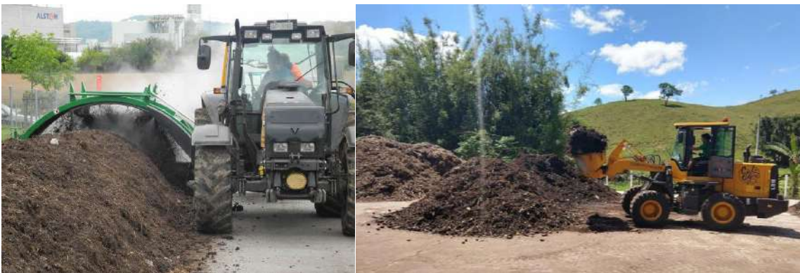
Figura 14: Revolvimento de leira de compostagem com 2 exemplos de geometria de leira e maquinário. Fonte: Internet e própria (2019).
