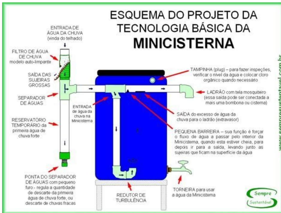
Figura 7: Esquema do sistema pertencente à minicisterna urbana e suas funções. Fonte: Site Sempre Sustentável, 2020.
