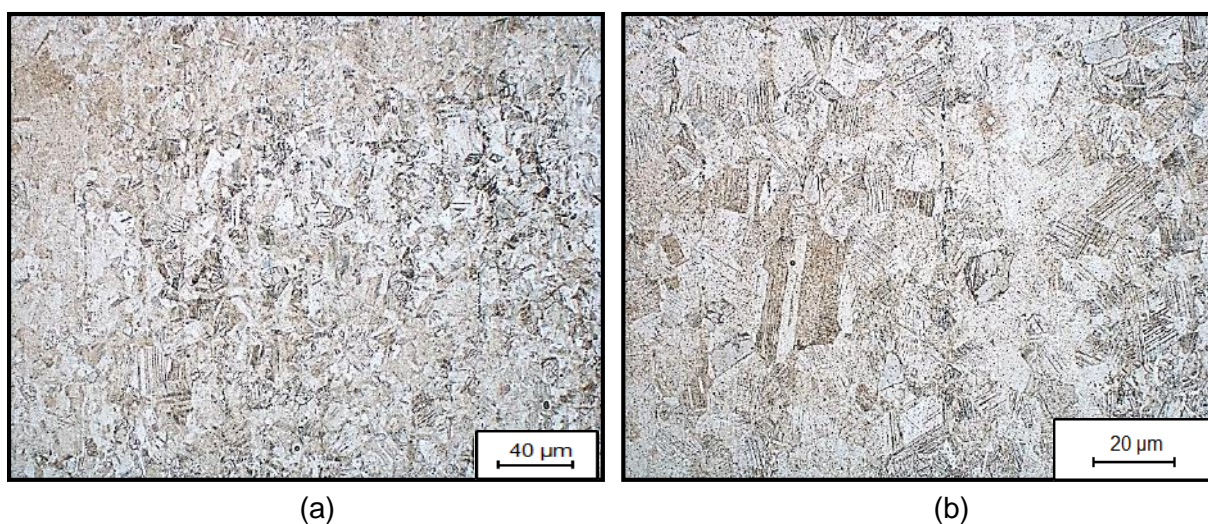
Figura 5.1.4: Microestrutura do aço ASTM 304 revelada através de Kane e V2A-Beize. Em (a) tem-se um aumento de 100X enquanto em (b) tem-se um aumento de 200X.
