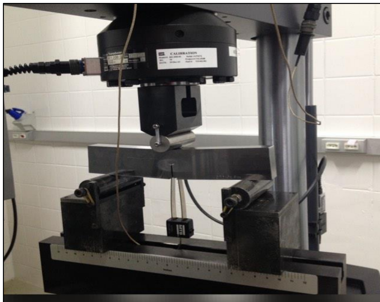
Figura 19: Corpo de prova de fratura com geometria de flexão em 3 pontos SE(B) sendo testado.
