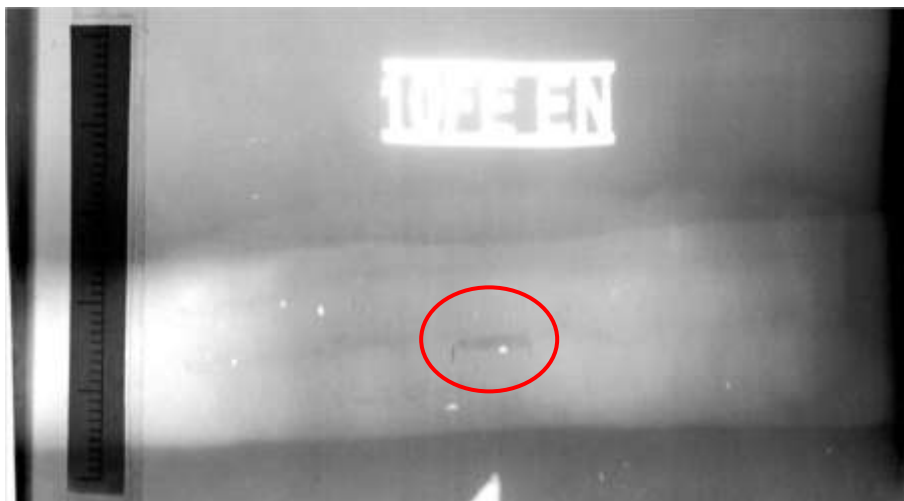
Figura 3.2 – Validação da técnica de grafite como representação de defeitos e verificação do posicionamento e orientação do grafite no cordão de solda.
