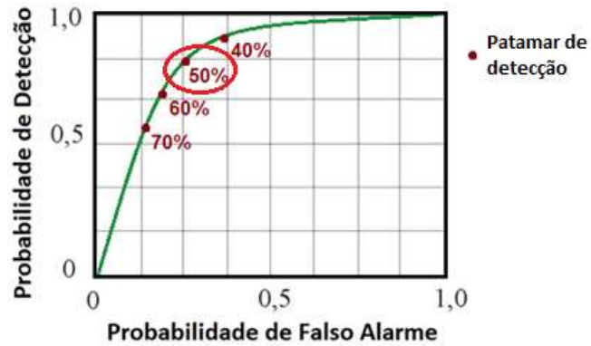
Figura 2.18 – Exemplo de modelagem da curva ROC com destaque em vermelho na região mais adequada para estabelecer o Patamar de detecção.
