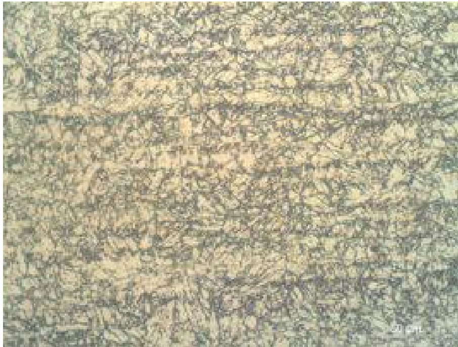
Figura 2.3: Microestrutura martensítica típica de chapa do aço 9% Ni. [1].
