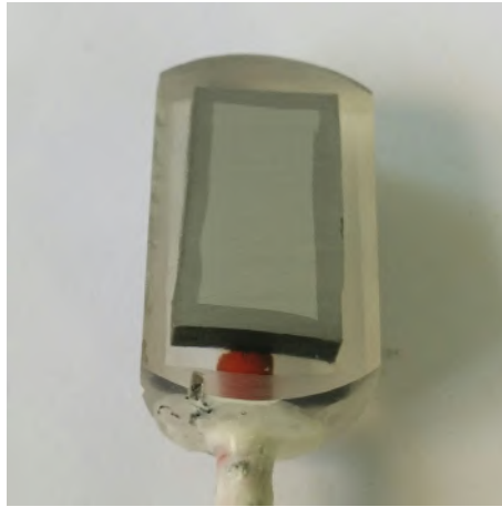
Figura 3.3: Eletrodo de trabalho para célula eletroquímica.
