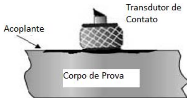
Figura 6: Inspeção realizada com transdutor de contato (Adaptado de [9]).
