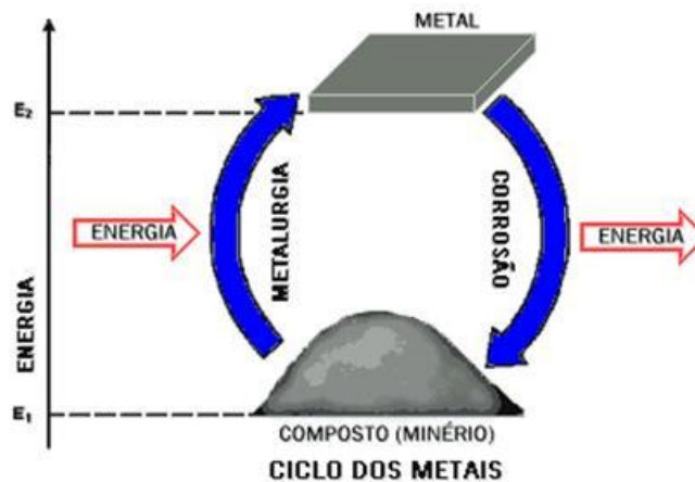
Figura 19: Processo de corrosão em metais [3].
