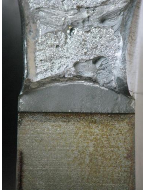
Figura 67: Fractografia do CP1 – X80LH ao ar por estereoscópio.
