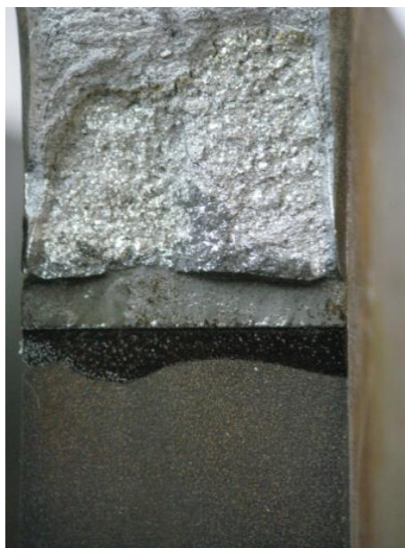
Figura 64: Fractografia do CP3 – X80HH hidrogenado por estereoscópio.
