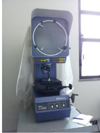
Figura 42: Projetor de Perfil usado na medição de pré-trinca
