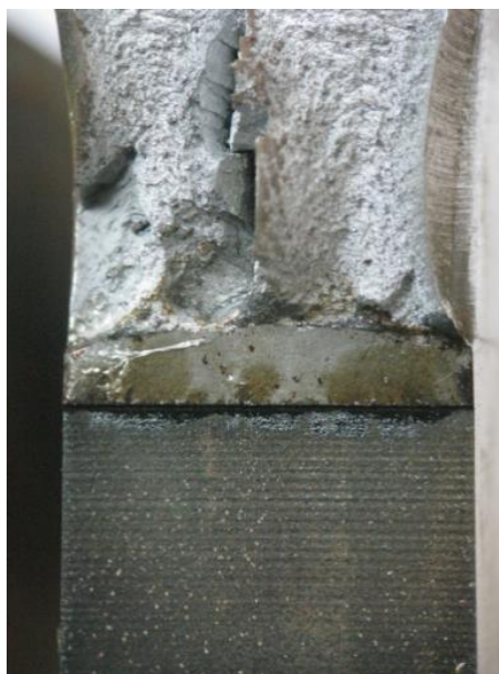
Figura 70: Fractografia do CP4 – X80LH hidrogenado por estereoscópio
