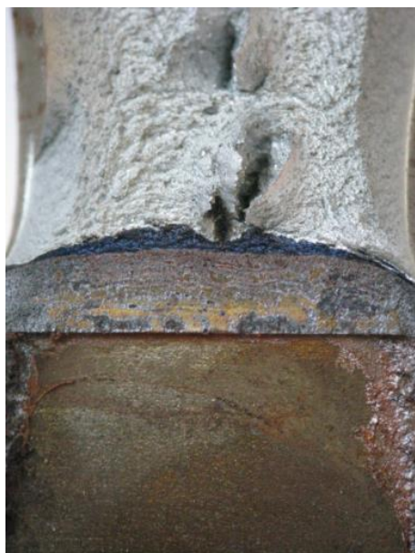
Figura 73: Fractografia do CP2 – X80LH hidrogenado 2h por estereoscópio
