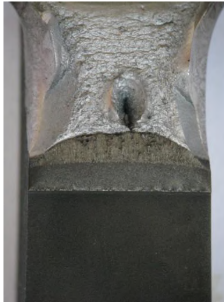
Figura 58: Fractografia do CP2 - MB hidrogenado por estereoscópio.
