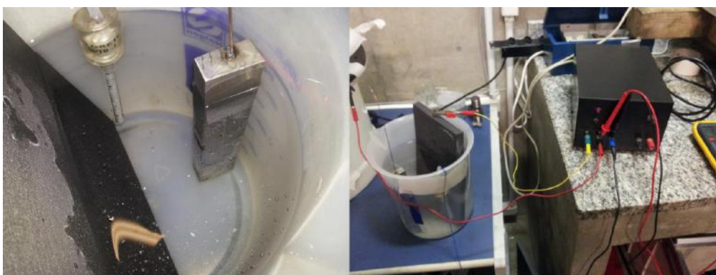
Figura 44: Fotos do sistema de hidrogenação por proteção catódica em solução aquosa 3.5% NaCl com sobretensão aplicada de -1,05\text{V}
