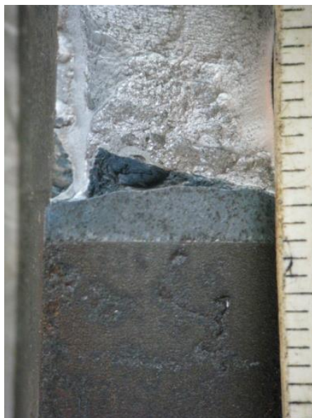
Figura 77: Fractografia do CP2 – X80LH hidrogenado 96h por estereoscópio
