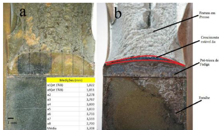
Figura 41: (a) Esquema de medição da pré-trinca de fadiga (b) Diferentes regiões da superfície de fratura após ensaio
