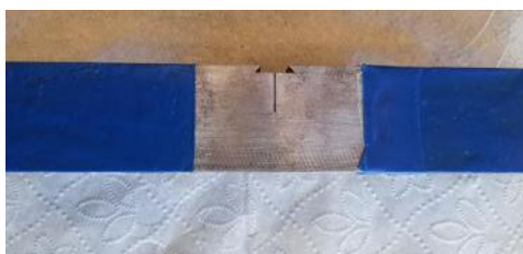
Figura 45: Corpo de prova pintado com tinta isolante para confinar a área de evolução de hidrogênio nas proximidades da pré-trinca
