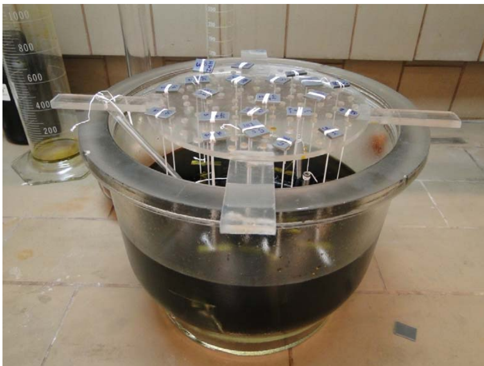
Figura 35 – Arranjo utilizado no ensaio ASTM G48.
