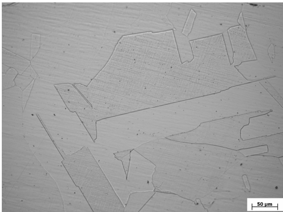
Figura 50 - Micrografia da ZTA da junta MB_SOLUB_HH com aumento de 200x, revelado utilizando o ataque eletrolítico com ácido oxálico 10%, com ddp de 6V, por 150 segundos.
