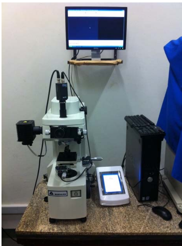
Figura 32 – Microdurômetro Vickers utilizado no ensaio de dureza.
