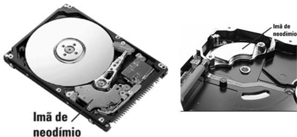
Figura 10. Localização dos ímãs de neodímio em discos rígidos.
