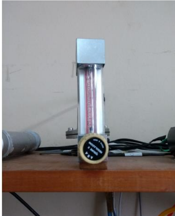
Figura 11: Rotômetro para ajuste de vazão utilizado no laboratório de bioprocessos na Embrapa-solos Fonte: Autor
