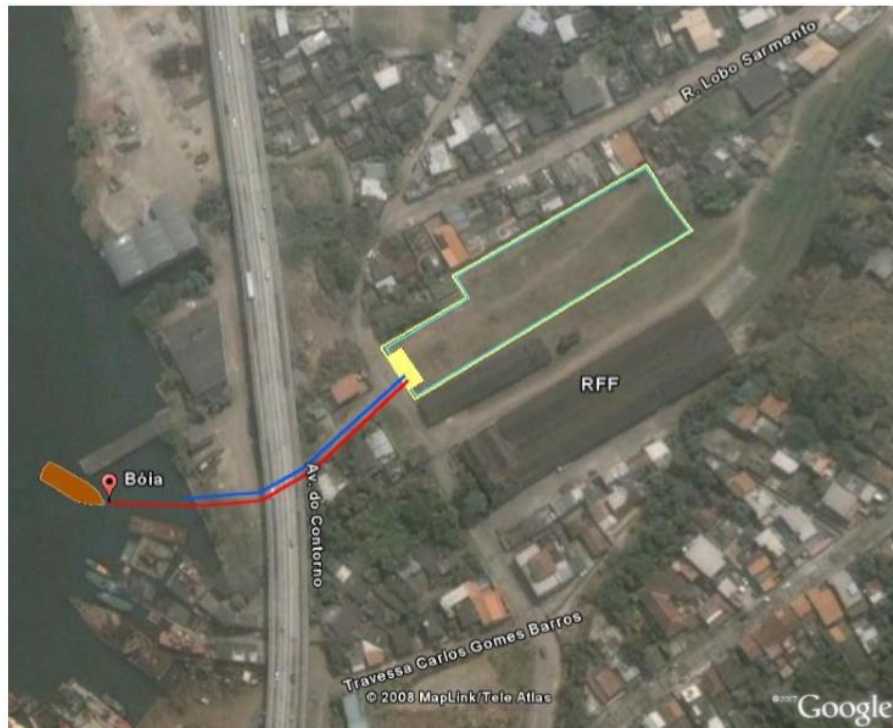
Figura 15: Localização da draga no ato da descarga de areia e tubulações subterrâneas de recalque do material (linha em vermelho) e retorno da água drenada (linha em azul).
