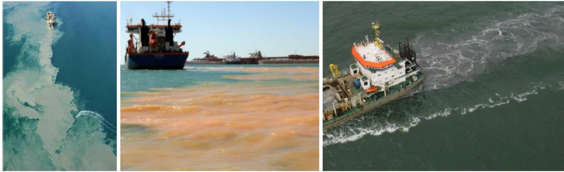
Figura 36: Dois exemplos de dragas gerando plumas de “ overflow ” na superfície, e um exemplo sem pluma de “ overflow ” visível na superfície.
