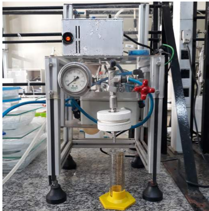
FIGURA 3.1: Equipamento para aferição do índice de incrustação.
