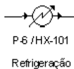
Figura 21: Etapa de refrigeração do biogás
