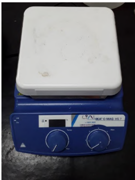
Figura 3-4 Placa de aquecimento e agitação magnética marca IKA
