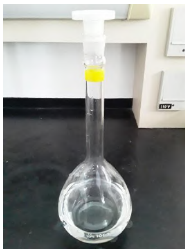
Figura 3-5 Balão volumétrico de vidro usado para avolumar licor de alimentação
