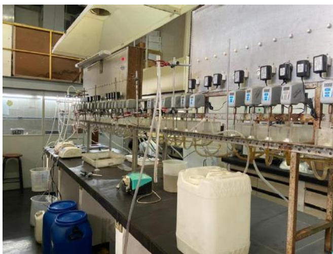
Figura 3-11 Aparato de planta mini-piloto para extração em regime contínuo
