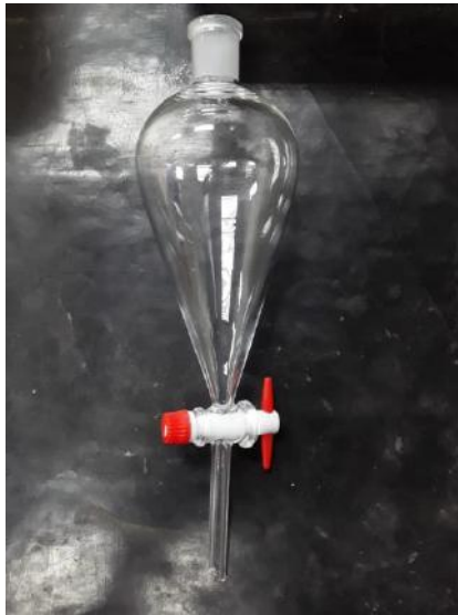
Figura 3-10 Funil de separação usado para mistura e repouso das fases
