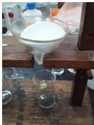
Figura 3-8 Filtração para separar fases aquosa e orgânico usando papel 1PS
