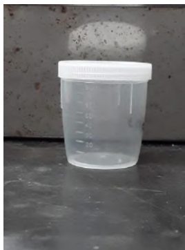
Figura 3-6 Frasco plástico utilizado para misturar as fases aquosa e orgânica
