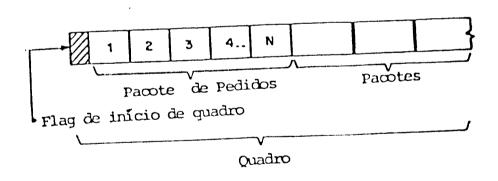
Cada estação conectada a barra, possui um bit específico no pacote de pedidos de transmissão. Alterando esse bit, a esta ção indica que deseja transmitir um pacote dentro desse qua dro. Ao fim do passo de pedido de transmissão, todas as esta
