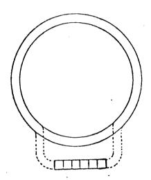
Uma nova mensagem só pode ser enviada pela estação quando o registro for retirado do anel o que só pode ocorrer quando não houver mensagem chegando.
