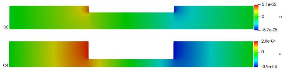
Figura 4.12: Resultados para a pressão ao longo do poro nos casos com fluido pseudo-plástico, R_0 = 10\mu m e Re = 0.01 . (a) \delta = 0.2 (b) \delta = 0.6 .
