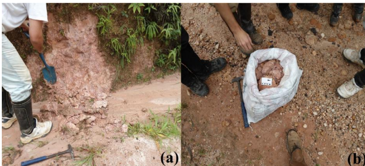
Figura 5 – Etapas de coleta da amostra de saprólito em campo. a – Limpeza do afloramento; b – Coleta de cerca de 20 kg de saprólito.
