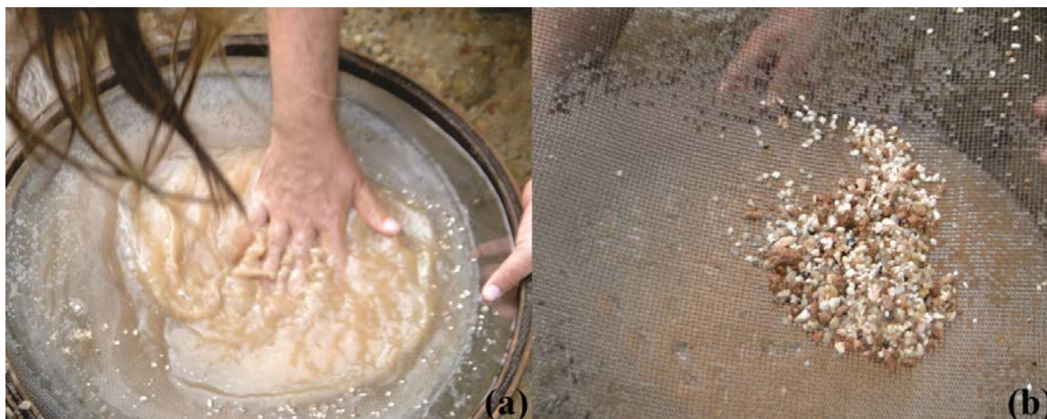
Figura 7 – Separação granulométrica com peneira com abertura de 2 mm. a - Processo de peneiramento para a retirada do material maior que 2 mm; b - Resíduo maior que 2 mm.
