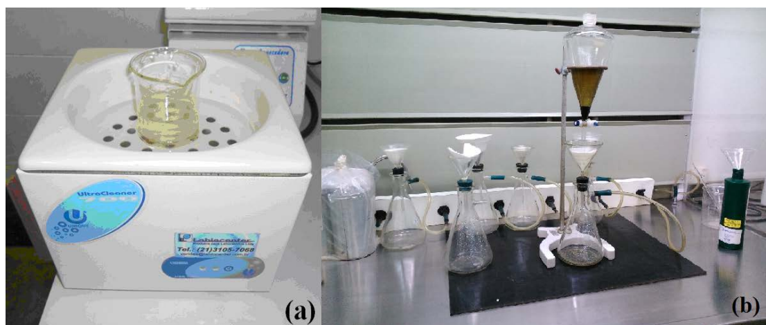
Figura 11: a – Limpeza da amostra com uso do ultrassom, extraíndo o material argiloso dos grãos; b – Separação dos minerais pesados por densidade com bromofórmio.
