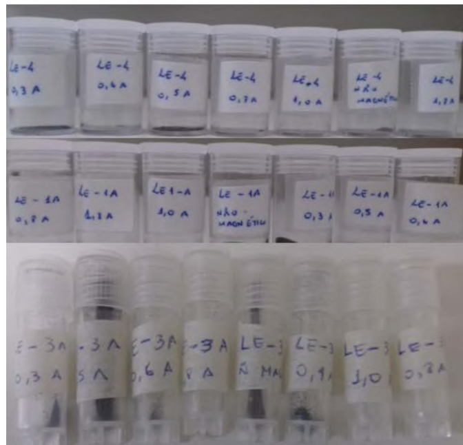
Figura 13: Frações finais do separador magnético isodinâmico Frantz nas amperagens utilizadas.
