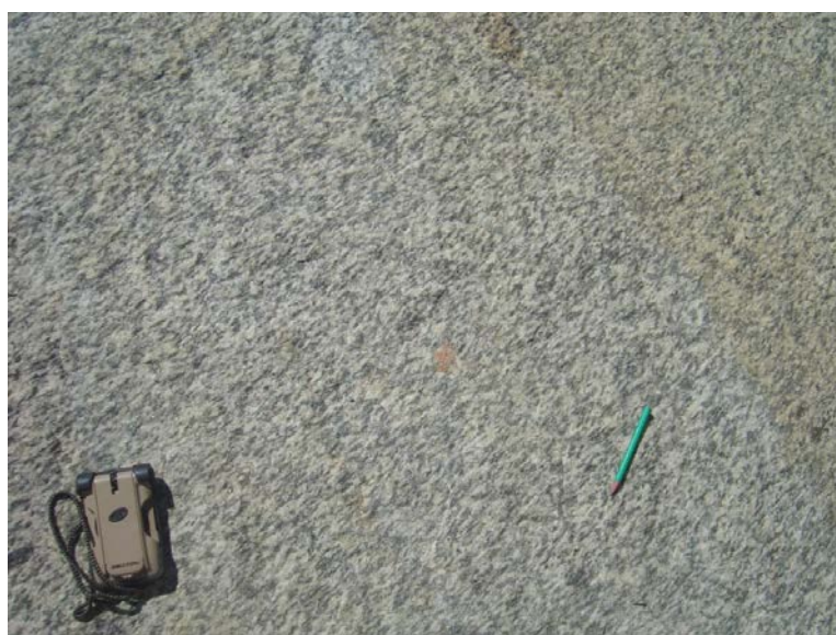
Figura 28 - Aspecto geral de amostra do ortogneisse Resende Costa em um corte paralelo a foliação, onde se destacam os aglomerados de biotita (Foto: Victor Hugo Souza).
