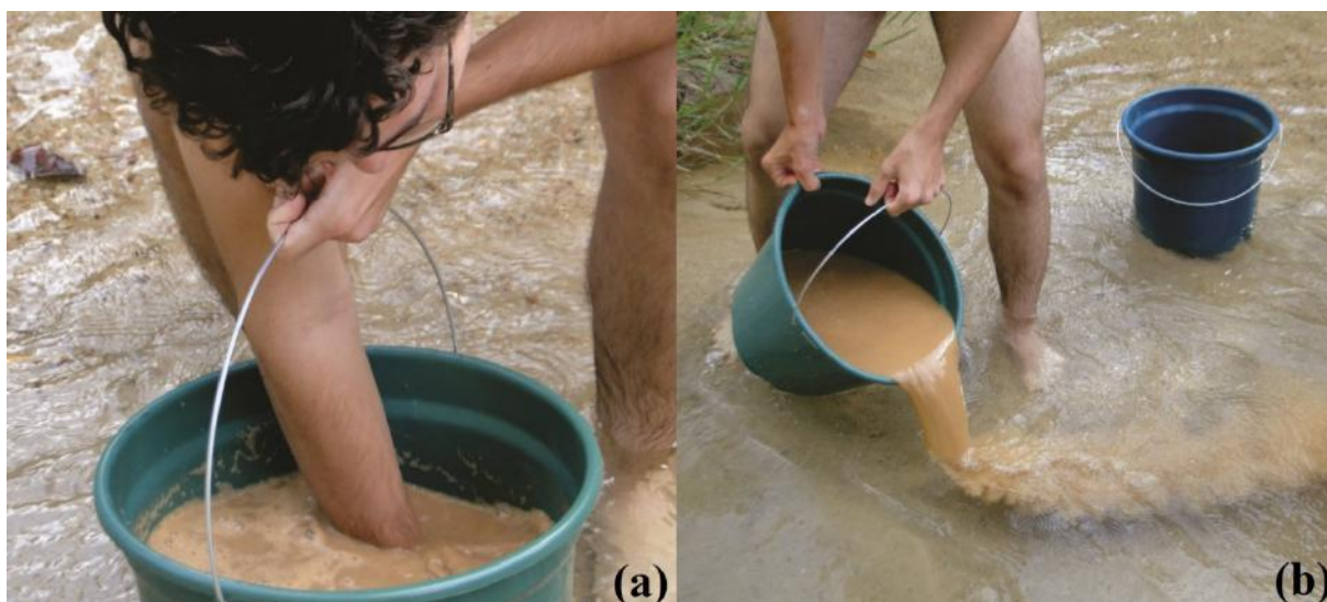
Figura 6 – Deslamagem do saprólito em uma drenagem ativa. a – Desagregação da amostra com a mão; b – Eliminação da argila e do silte em suspensão a partir da retirada da água.
