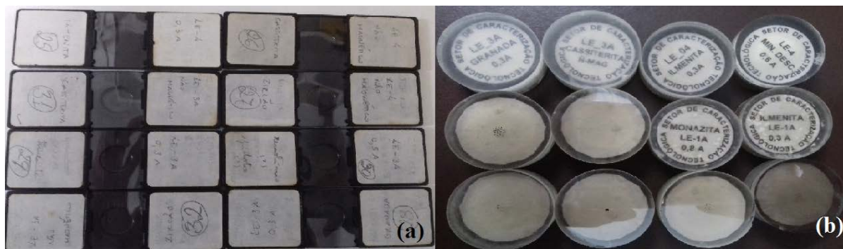
Figura 15: a - Porta amostra para os grãos. b -Seções polidas preparadas a partir dos grãos separados.
