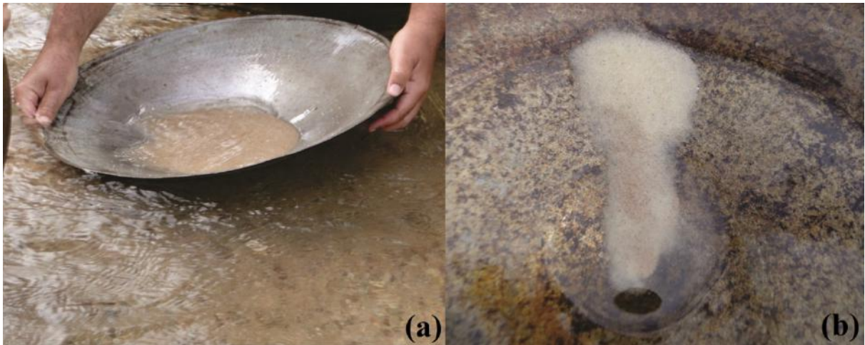
Figura 8 – Utilização da bateia para concentração gravítica dos minerais pesados. a – Início do processo com o material menor que 2 mm separado com o uso da peneira; b – Concentrado parcial com resíduos compostos dos minerais pesados no fundo da bateia.
