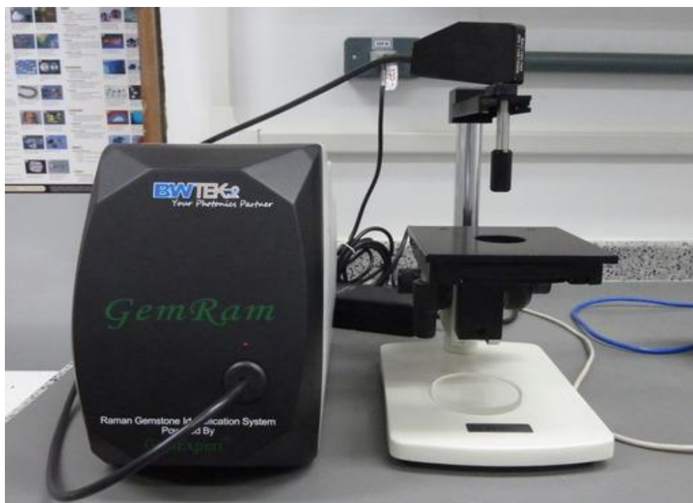
Figura 22 - Espectrômetro portátil GemRam - Raman Gemstone Identification System, da B&W Tek.
