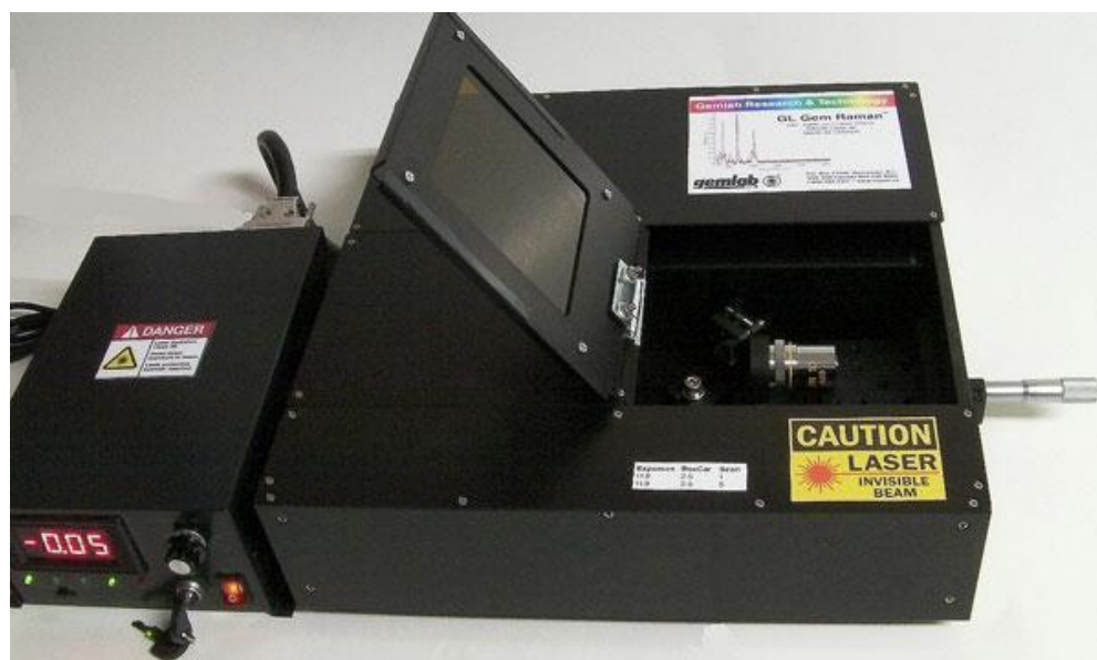
Figura 23 - Espectrômetro Raman portátil GL Gem Raman PL 532, da GemlabGroup.
