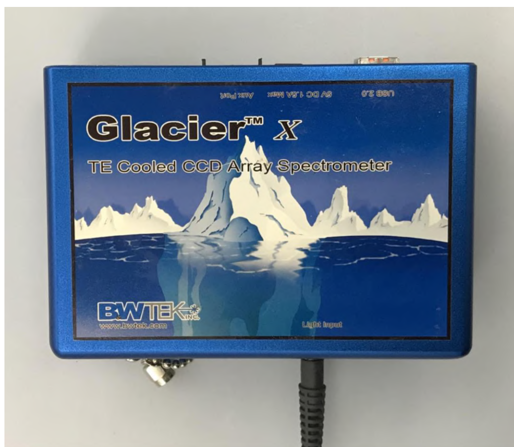
Figura 25 - Espectrômetro portátil da marca BWTEK, modelo Glacier X.
