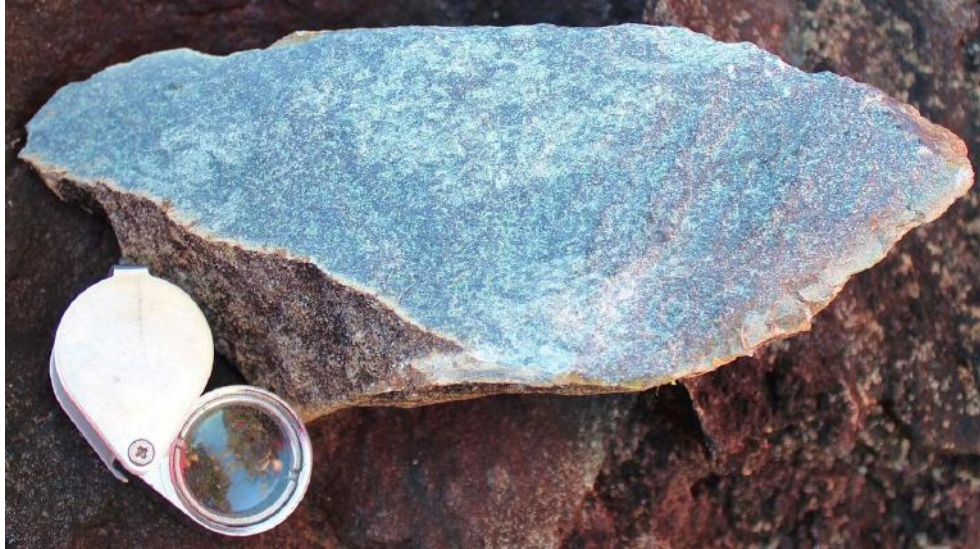
Figura 12 – Amostra de granulação fina e bem preservada de serpentinito da sequência metaúltramáfica exibindo cristais de serpentina (cor cinza azulada) e clorita (esverdeada). Presença de veio de quartzo de cor cinza (Ponto OG-I-75).
