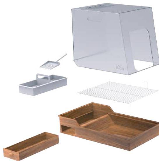
Figura 100 - Sanitário Kiba em vista explodida
