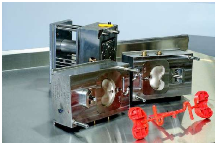
Figura 133 - Molde industrial para máquina injetora de termoplásticos com uma peça produzida ao lado
