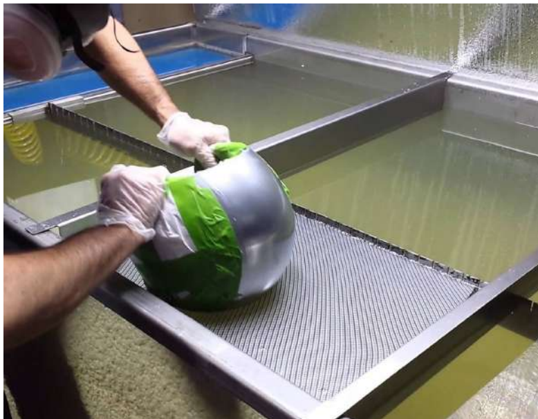
Figura 130 - Processo de transferência de imagem por pintura hidrográfica
