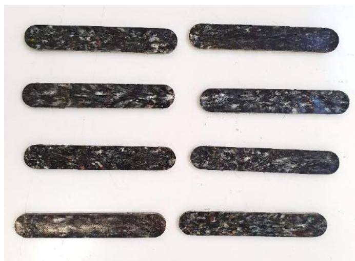
Figura 12: Corpos de prova de “Fundo de tanque” utilizados na análise dinâmico-mecânica.
