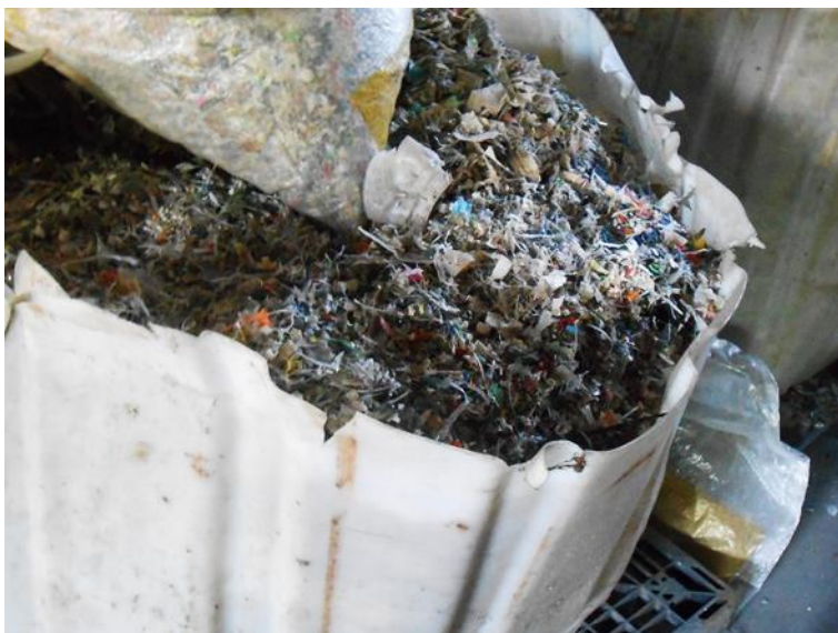
Figura 8: Container com os resíduos do processo de separação por gravidade na cooperativa de reciclagem.
