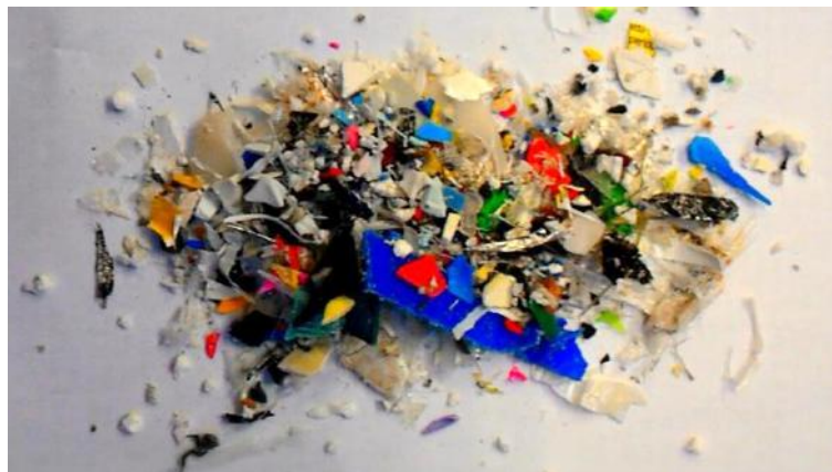
Figura 10: Amostra de “Fundo de tanque” após ser lavado e triturado em liquidificador basculante industrial.
