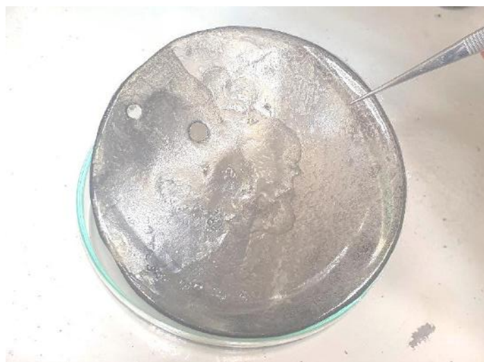
Figura 17: Filme polimérico formado após a evaporação de clorofórmio após a dissolução seletiva.
