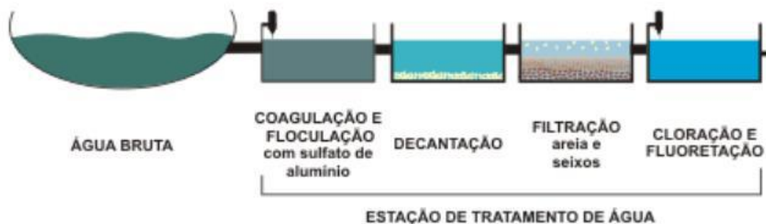
Figura 2 - Fluxograma de tratamento de água (KOTHE, s.d.)
