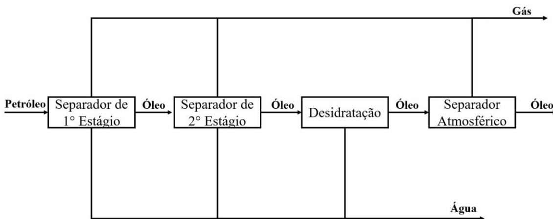
Figura 3 – Esquema simplificado de separação comumente empregado em plataformas offshore . Baseado em SILVA (2018).
