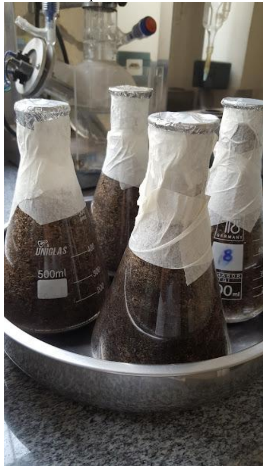
Figura 3.15: Biomassa após sofrer hidrólise ácida em autoclave
