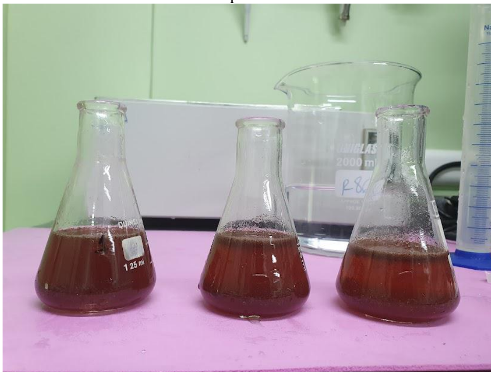
Figura 3.3: Frascos para autoclavagem, contendo o meio para caracterização da matéria-prima
