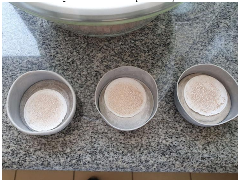
Figura 3.8: Membranas após calcinação
