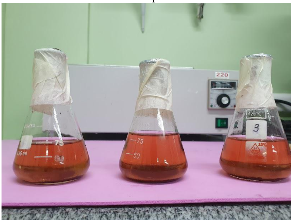
Figura 3.4: Frascos após a autoclavagem, contendo o meio para caracterização da matéria-prima
