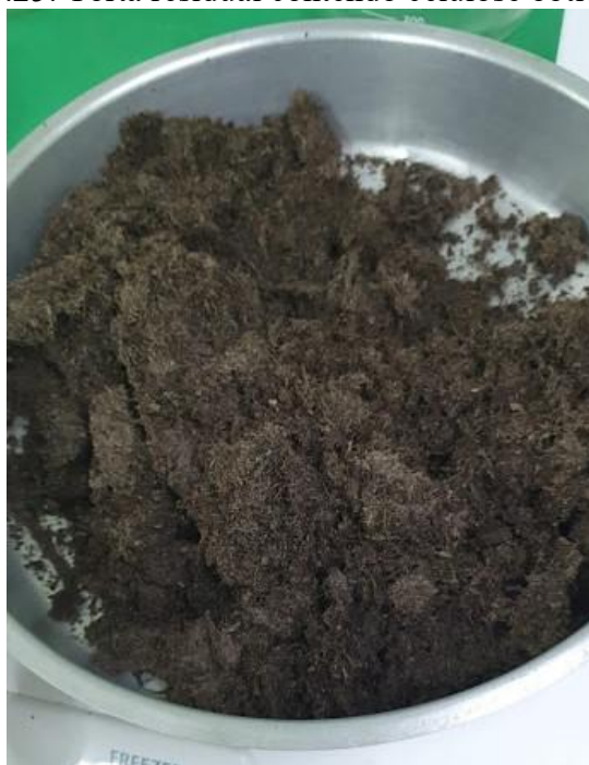
Figura 3.25: Torta residual contendo celulose obtida na prensagem
