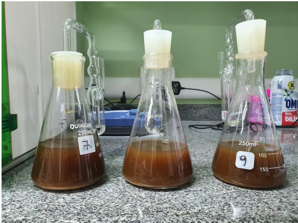
Figura 3.38: Sistema de fermentação correspondente a 75% de hidrolisado hemicelulósico
