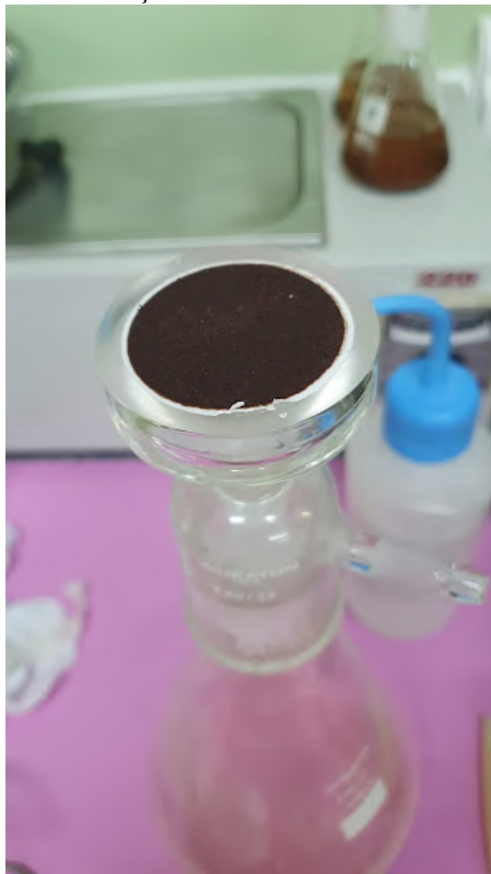
Figura 3.5: Filtração com membrana dos hidrolisados
