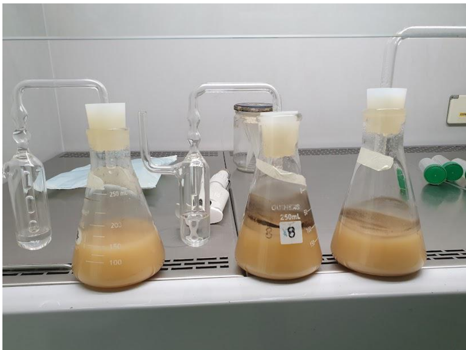
Figura 3.42: Fim da fermentação do sistema correspondente a 75% de hidrolisado celulósico
