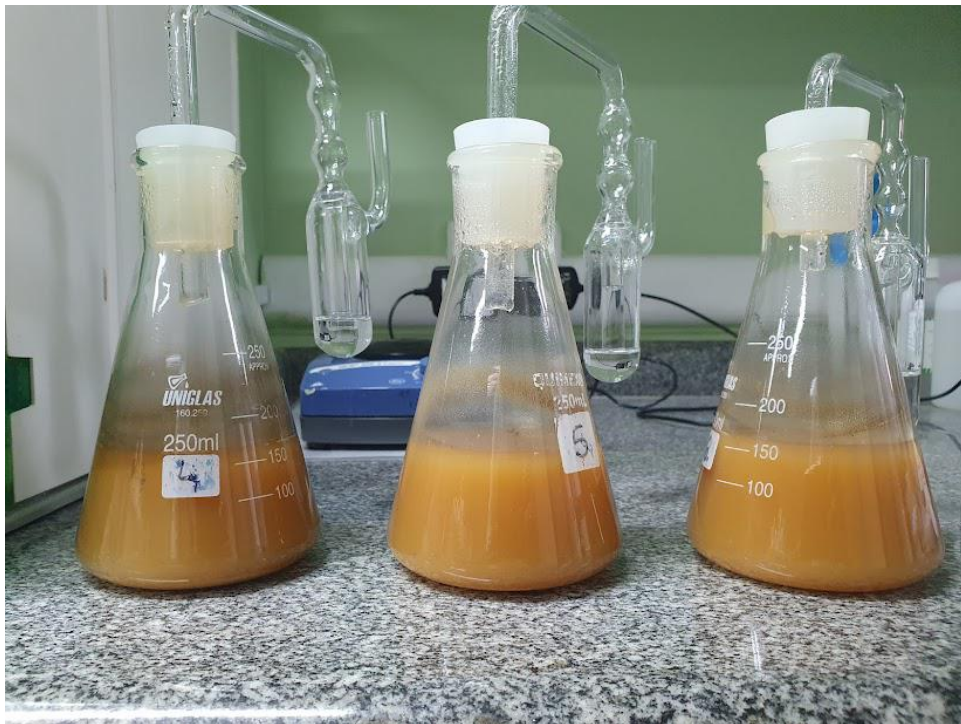
Figura 3.43: Fim da fermentação do sistema correspondente a 50% de hidrolisado hemicelulósico
