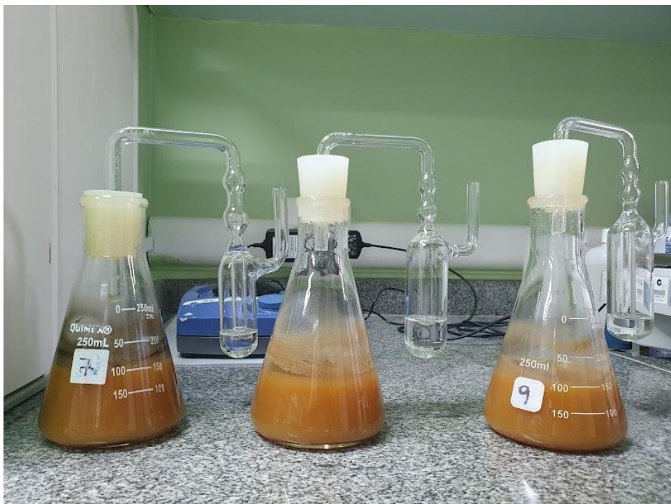
Figura 3.44: Fim da fermentação do sistema correspondente a 75% de hidrolisado hemicelulósico
