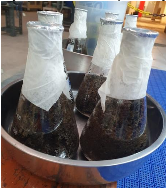
Figura 3.28: Hidrolisados obtidos após autoclavagem
