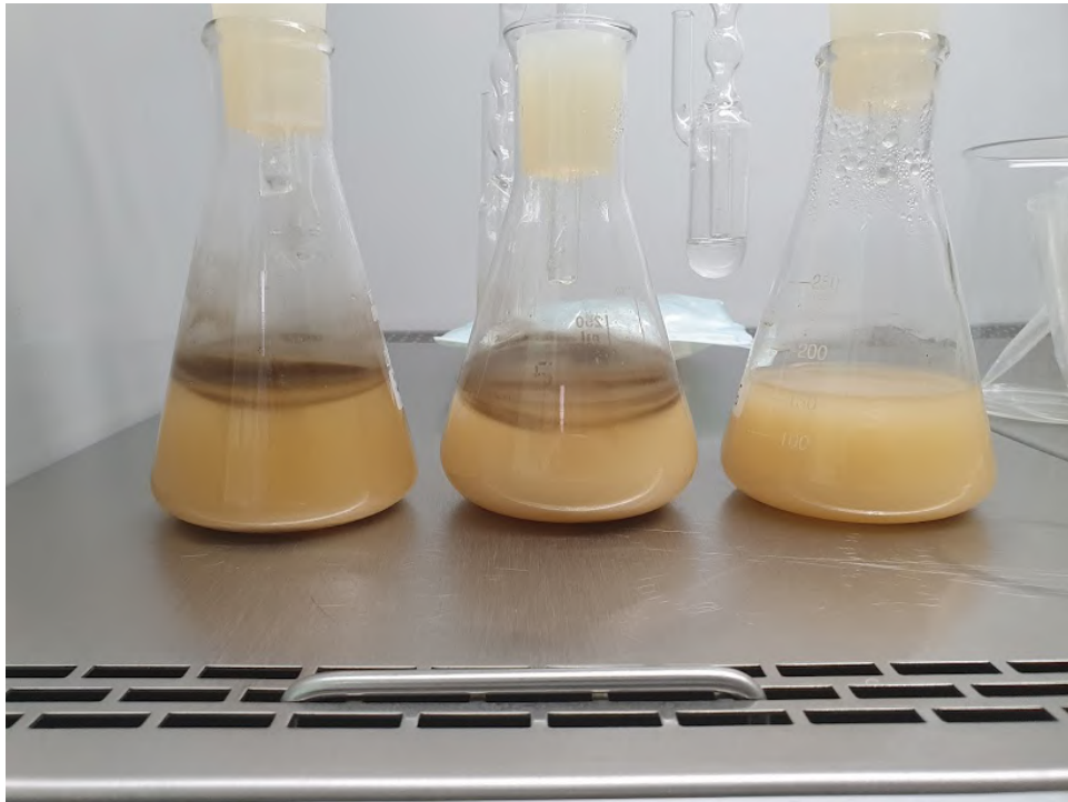
Figura 3.41: Fim da fermentação do sistema correspondente a 50% de hidrolisado celulósico
