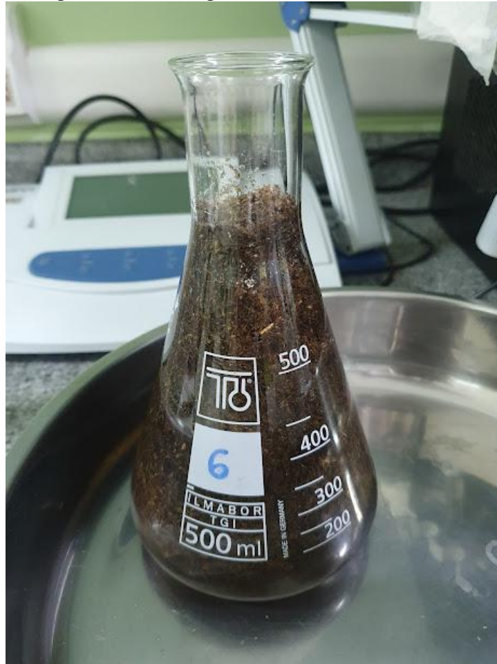
Figura 3.23: Celulignina a sofrer hidrólise básica
