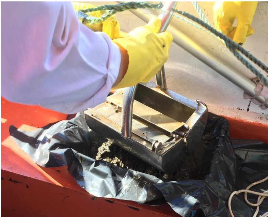
Figura 5 – Draga do tipo Van Veen utilizada na coleta dos sedimentos.
