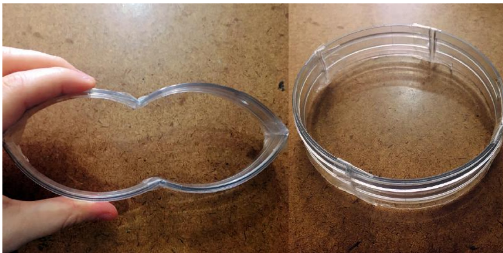
Figura 54 - Estudo comportamento do fechamento circular em PET (Fonte: acervo da autora)
