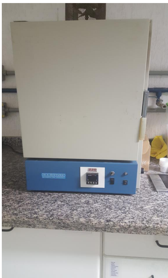
Figura 12- Estufa utilizada para o processo de envelhecimento térmico
