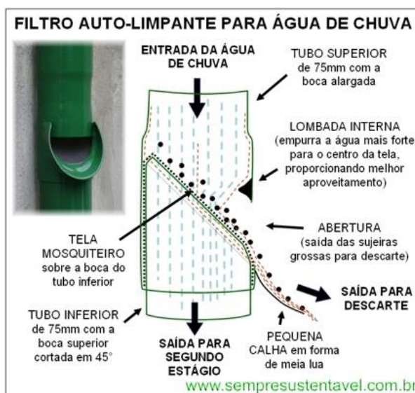
Figura 31: esquema do filtro autolimpante
