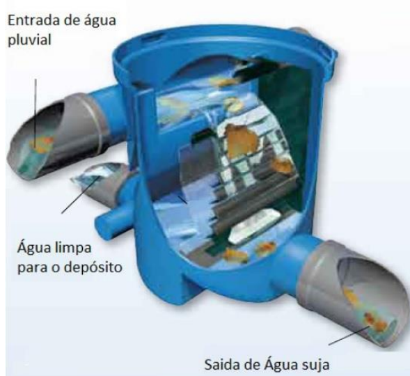
Figura 5: filtro de água pluvial
