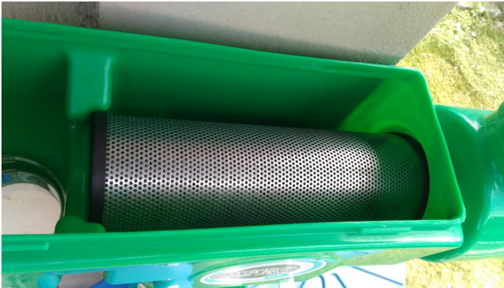
Figura 22 - Cone de aço utilizado para a remoção de sólidos grosseiros.
