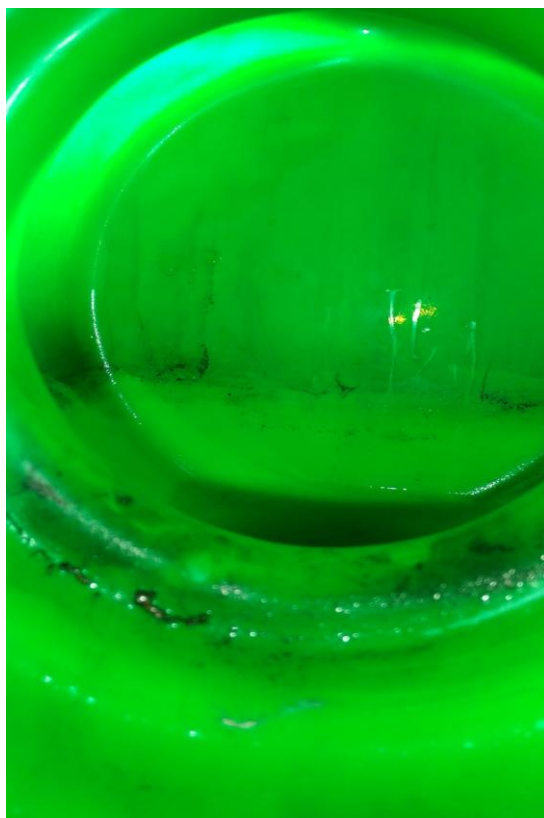
Figura 39 – Marca do nível da água acumulada no interior do equipamento.
