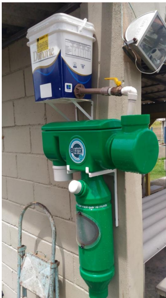
Figura 30 – Esquema experimental para avaliação da cloração do aparelho.
