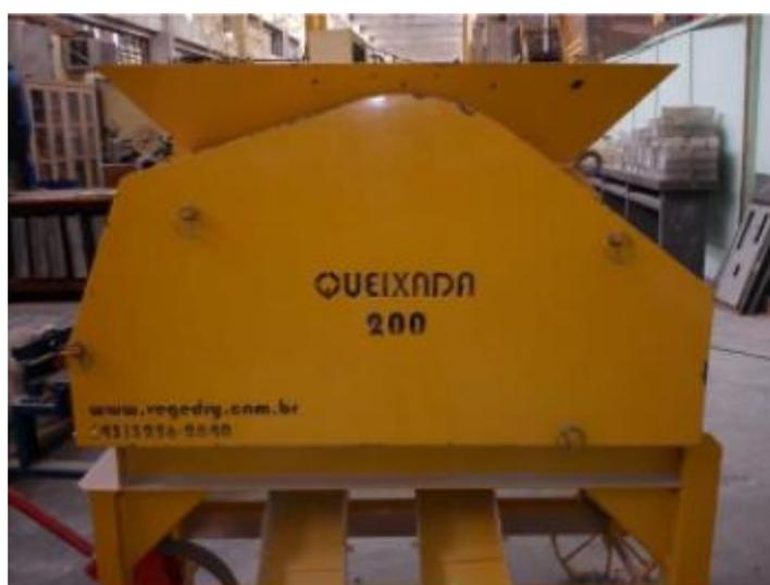
**Figura 9:** Britador de mandíbulas móveis QUEIXADA 200 utilizado para triturar os RCD
