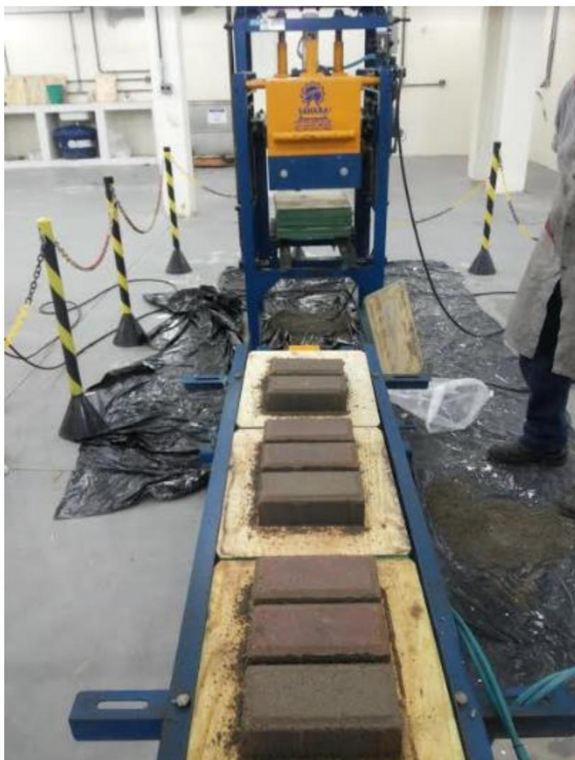
**Figura 11:** Blocos de pisos intertravados de concreto produzidos na vibroprensa
