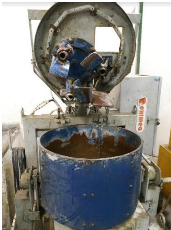
**Figura 10:** Misturador Planetário utilizado para misturar os constituintes dos concretos
