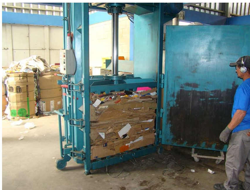
Figura 18: Processamento do papel selecionado em fardos
