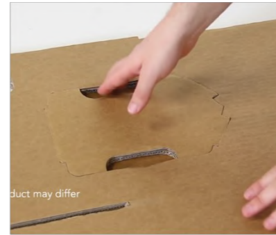
5- As peças são cortadas diretamente nas peças dos pés da mesa.
