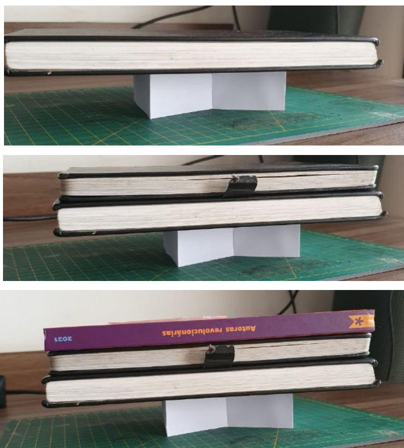
Figura 35: Sequência de testes de resistência da alternativa 3
