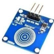
Figura 57 - Sensor de toque capacitivo (Fonte: https://www.armazemdaeletrica.com.br/ )
