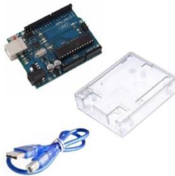
Figura 59 - Arduíno Uno, case em ABS e cabo USB. (Fonte: https://www.casadarobotica.com/ )
