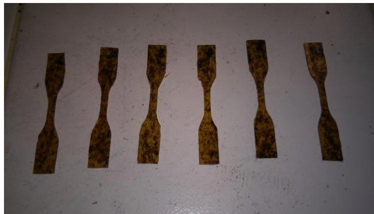
Figura 14 – Corpos de prova obtidos para o Compósito 5%Fibra + 1%compatibilizante Fonte: Autoria própria.
