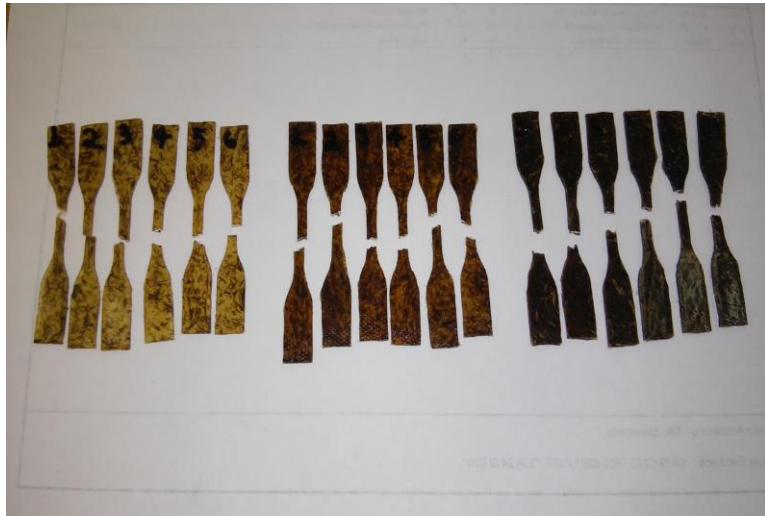
Figura 22 – Compósitos com 5,10 e 20% de fibra de bagaço de cana-de-açúcar retido em peneira de MESH 20 sem compatibilizante, após o rompimento no ensaio de Tração. Fonte: Aatoria própria.
