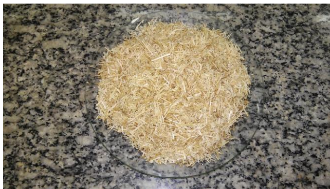
Figura 11 – Bagaço de cana-de-açúcar moído, peneirado e tratado com solução aquosa de NaOH 5% (m/v). Fonte: Autoria própria.
