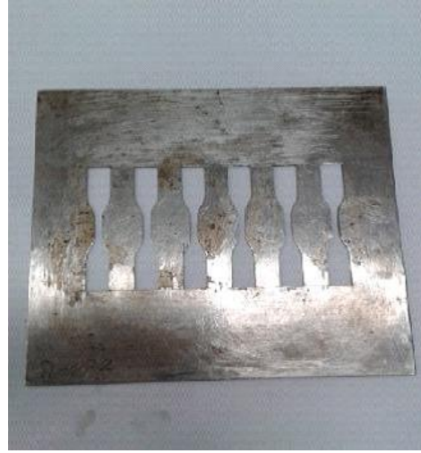
Figura 13 – Prensa hidráulica de bancada (à esquerda) e Molde para corpos de prova ASTM D638 (à direita). Fonte: Autoria própria.
