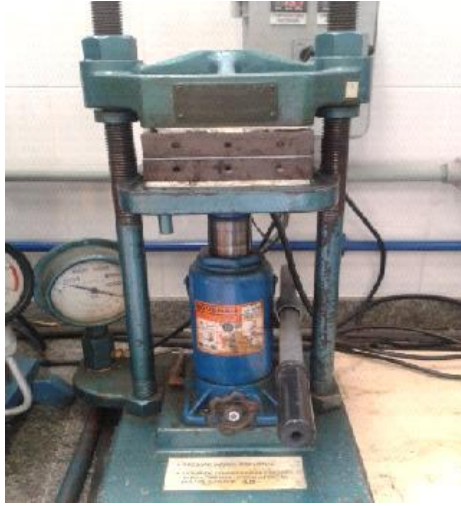
Figura 13 – Prensa hidráulica de bancada (à esquerda) e Molde para corpos de prova ASTM D638 (à direita). Fonte: Autoria própria.
