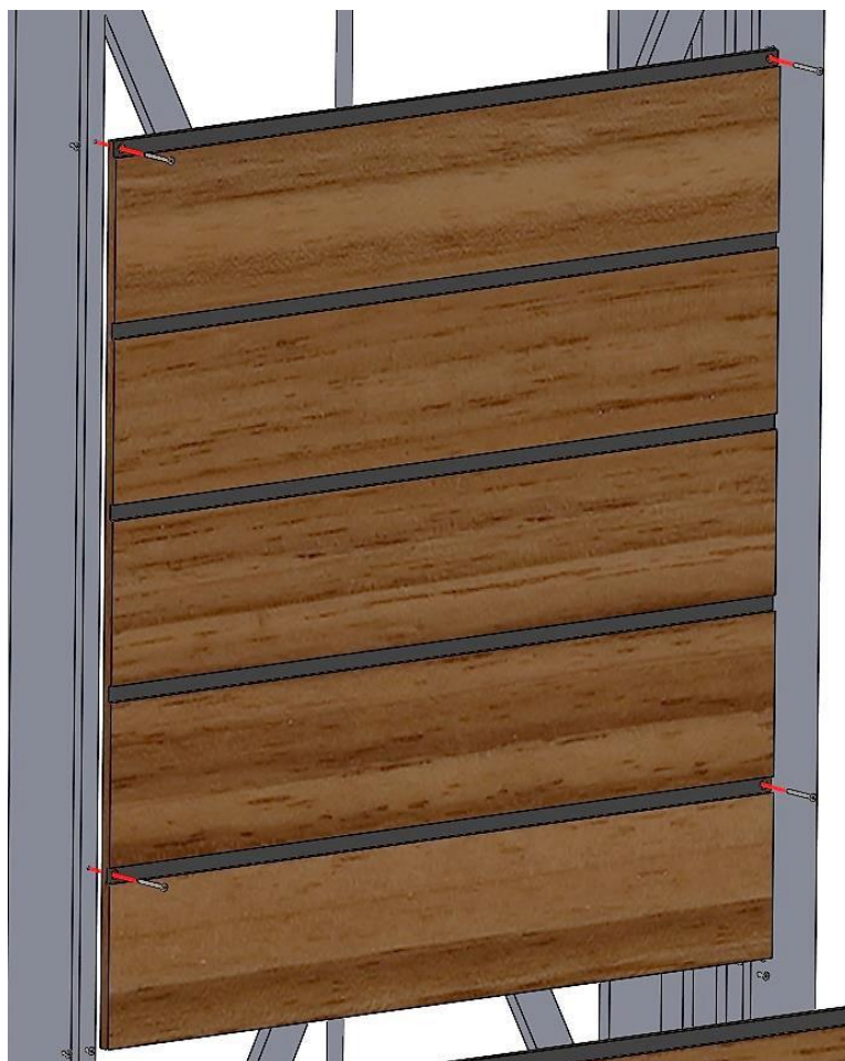
Figura 88 – Fixação do Módulo Painel Superior no Conjunto Torre (Fonte: elaboração própria).
