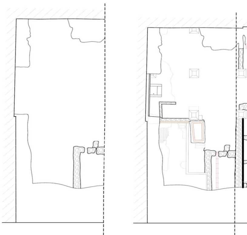
Figura 77. À esquerda, planta baixa original hipotética. À direita, planta baixa dos remanescentes arquitetônicos encontrados. Escala: 1:125. Autoria: Margareth Pereira Dias.
