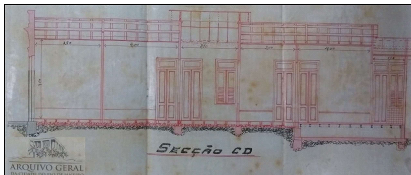
Figura 10. Arquivo Geral da Cidade do Rio de Janeiro . Corte lateral no sentido C/D, em que C é a seção virada para a Rua Riachuelo e D, a seção dos fundos.
