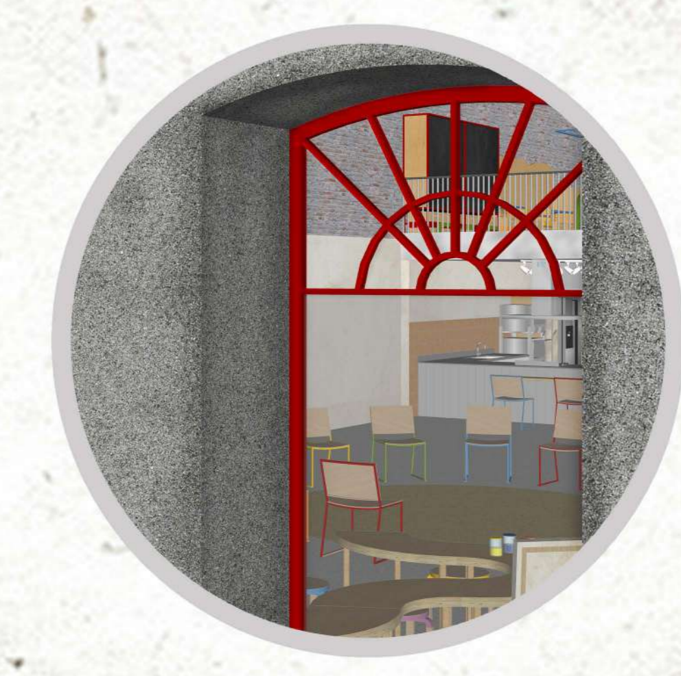
REABERTURA DO VÃO JÁ EXISTENTE, REEXIBINDO CANTARIA EM PEDRA ORIGINAL E CRIANDO UMA "VITRINE" PARA O ESPAÇO.
