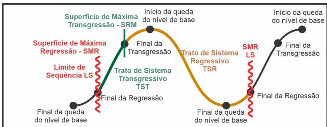
Figura 13- Curva senoidal que representa idealmente a variação do Nível de Base em uma bacia sedimentar. Todas as informações relevantes estão contidas na figura. Modificada de Catuneanu (2006 e 2017)
