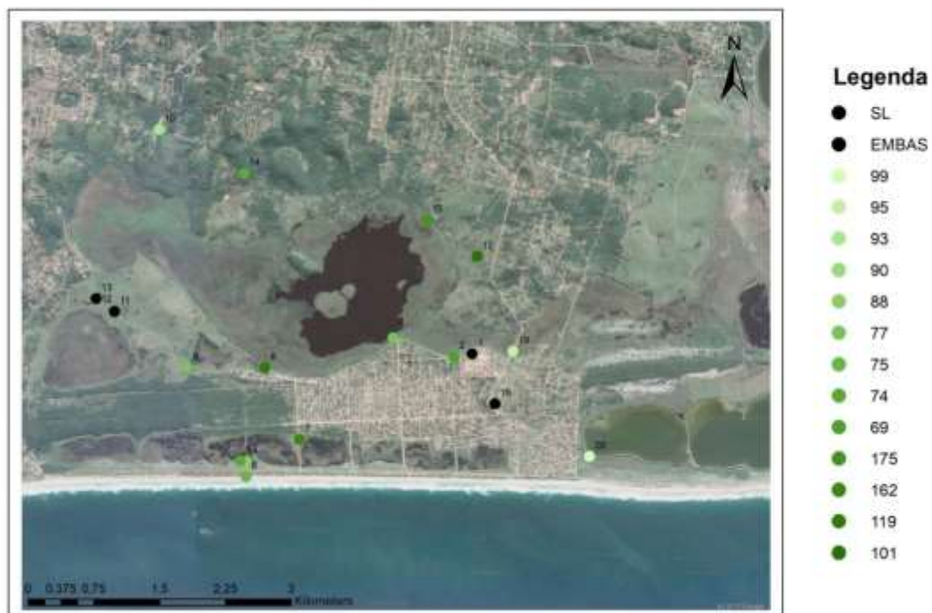
Figura 32 - Mapa com os potenciais de oxirredução das amostras de água coletadas nos pontos analisados em campo. Todos os valores são positivos, em mV.
