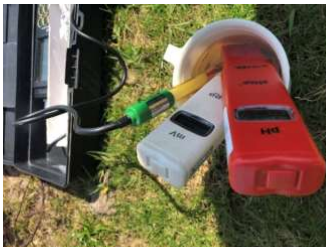
Figura 10 – Medidor de ORP Hanna HI98201 (branco) e Medidor de PH Hanna pHep Tester (vermelho).
