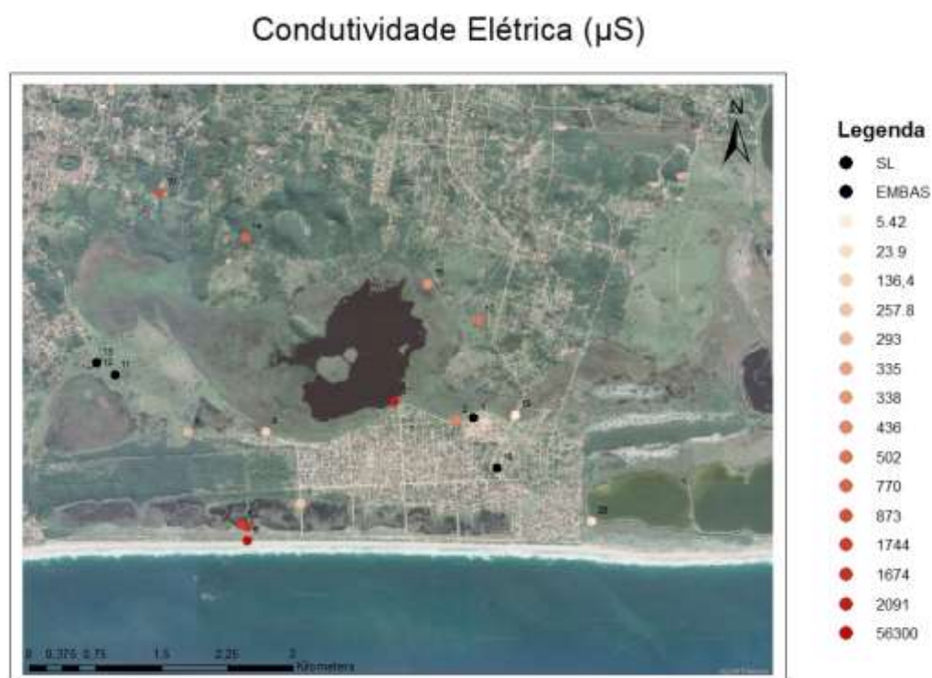
Figura 30 - Mapa com os valores de condutividade elétrica das amostras de água coletadas nos pontos analisados em campo.
