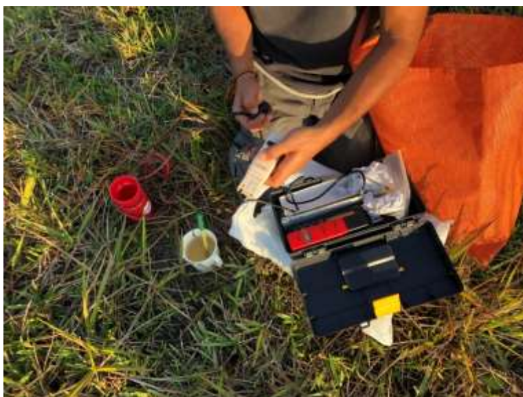
Figura 11 – Medindo o PH e o ORP de uma amostra de água da lagoa de Jacarepiá.
