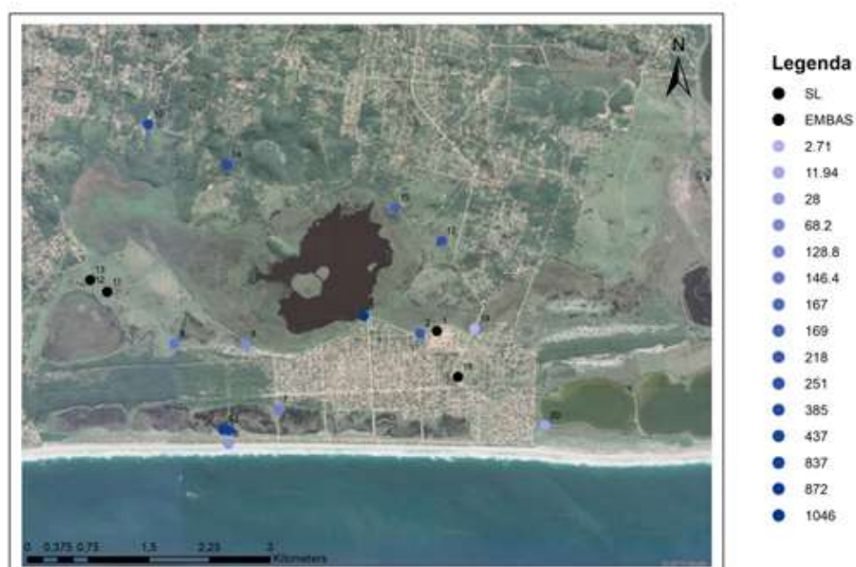
Figura 35 - Mapa com os totais de sólidos dissolvidos nas amostras de água coletadas nos pontos analisados em campo. Este dado está representado em mg/L.
