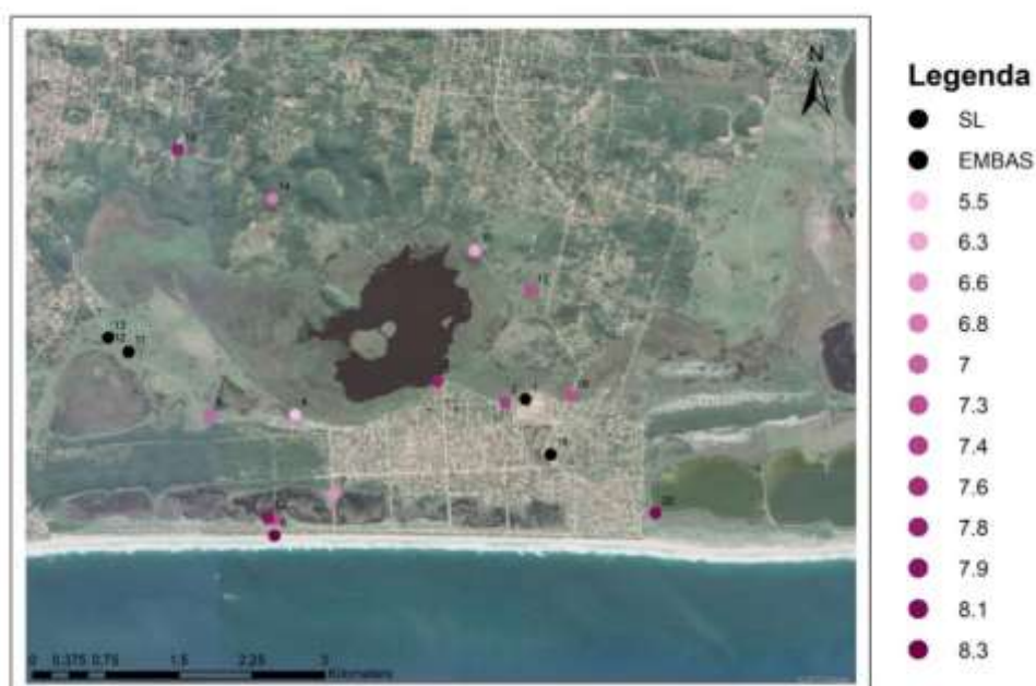
Figura 33 - Mapa com os potenciais hidrogeniônicos das amostras de água coletadas nos pontos analisados em campo.
