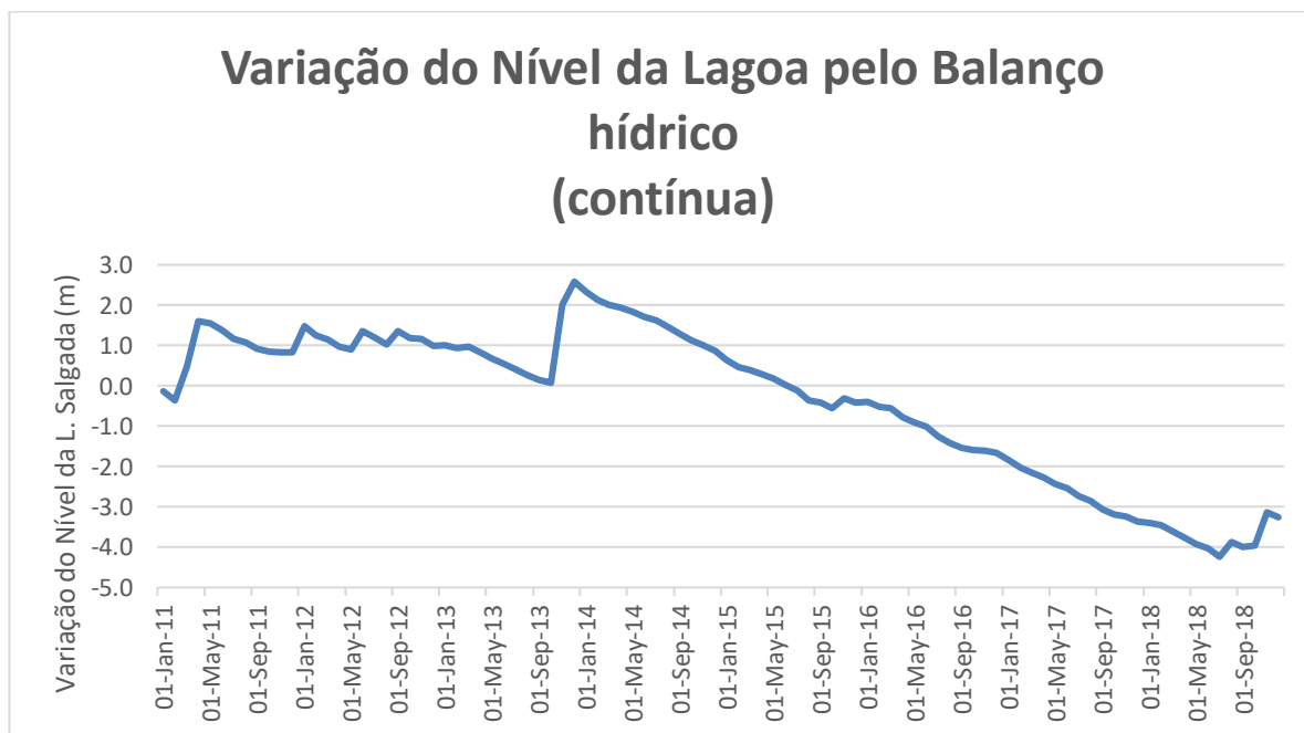
Figura 46 - Variação contínua do Nível da Lagoa pelo Balanço Hídrico
