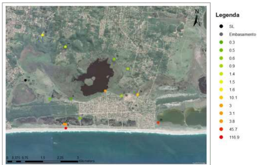
Figura 31 - Mapa com as concentrações de NaCl das amostras de água coletadas nos pontos analisados em campo. A unidade das medidas é mg/L.
