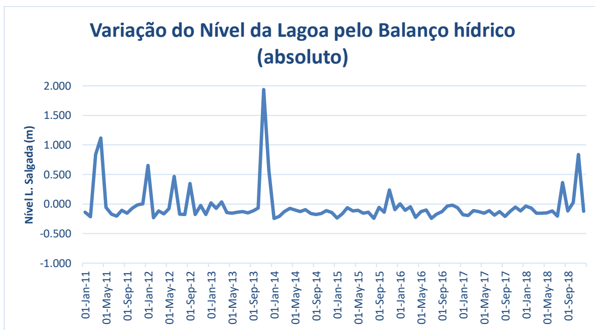
Figura 45 - Variação absoluta do Nível da Lagoa pelo Balanço Hídrico
