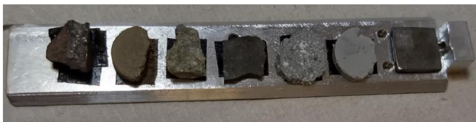
Figura 15 – Porta amostras contendo fragmentos de diversos meteoritos para análise PIXE. Fonte: allende.
