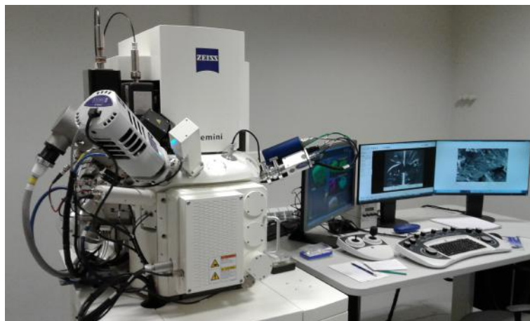
Figura 17 – Microscópio de varredura de feixe duplo (SEM-FIB), onde as análises MEV dos meteoritos SVP e Cebollati foram realizadas. Fonte: Centro Atômico de Bariloche.
