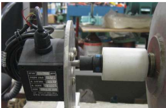
Figura 5.7: Encoder: transdutor de velocidade.
