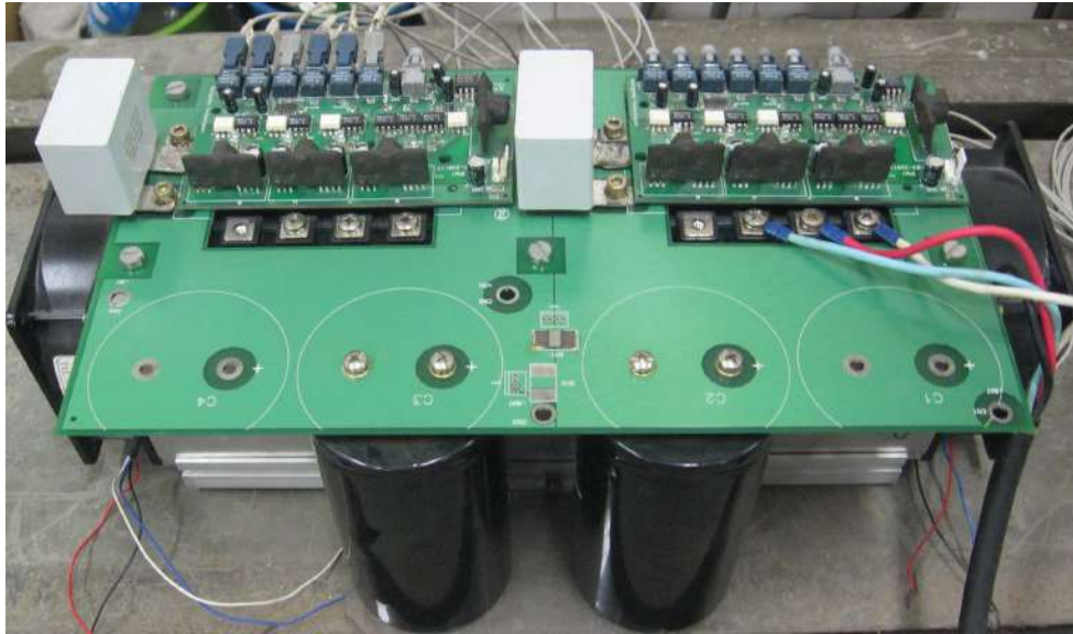
Figura 5.2: Bancada experimental: módulo de potência Back-to-back e drives de disparo óptico.
