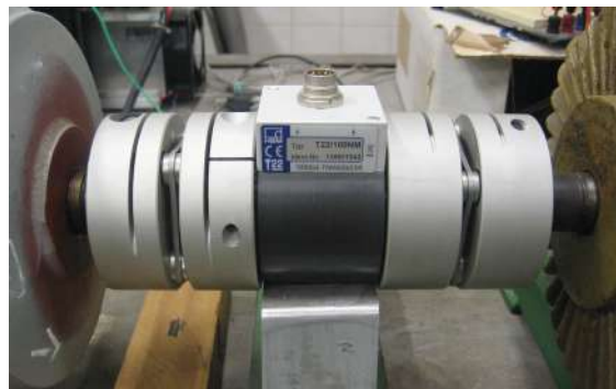
Figura 5.6: Torquímetro: transdutor de conjugado mecânico.
