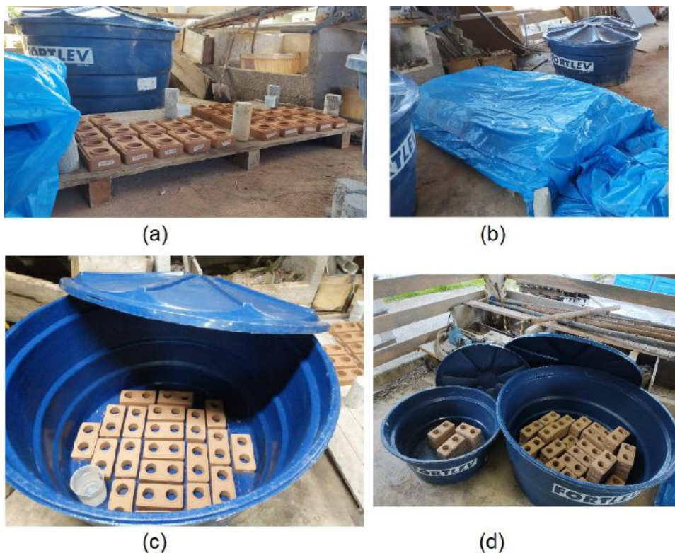
Figura 4-33 – Etapas do processo de cura dos tijolos solo-cimento (a) Disposição dos tijolos recém-moldados, já devidamente etiquetados, sobre o pallet ; (b) Cobertura do pallet com a lona plástica; (c) Disposição dos tijolos dentro da caixa d'água, juntos aos béqueres com água; (d) Empilhamento dos tijolos nas caixas d'água.
