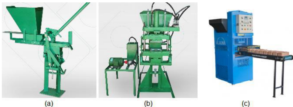
Figura 3-6 – Diferentes tipos de prensas de tijolos solo-cimento (a) Prensa manual mecânica; (b) Prensa manual hidráulica; (c) Prensa motorizada hidráulica. Fonte: (a) e (b) VIMAQPRENSAS (2022); (c) ALROMA (2022).
