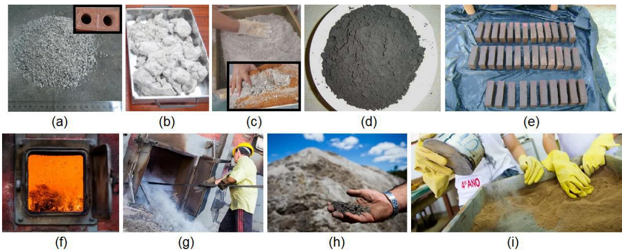
Figura 2-5 – Exemplos de adições orgânicas e inorgânicas ao tijolo de solo-cimento e solo-cal (a) Pó de brita; (b) resíduos de rochas ornamentais in natura ; (c) resíduos de rochas ornamentais seco em estufa e sendo misturado com solo tropical; (d) cinzas de casca de arroz; (e) blocos de solo-cal com cinzas de casca de arroz; (f) queima do bagaço da cana-de-açúcar; (g) e (h) cinzas do bagaço da cana-e-açúcar; (i) mistura de solo-cimento e as cinzas do bagaço da cana-e-açúcar.
