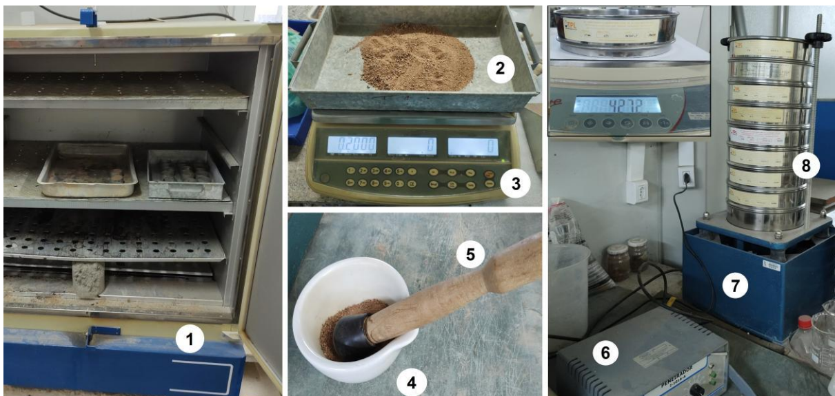
Figura 4-12 – Equipamentos utilizados no ensaio de peneiramento (1) Estufa; (2) Bandeja com a amostra de 200g; (3) Balança sensível a 0,01g. (4) Almofariz em porcelana; (5) Pistilo nº 2; (6) Painel de controle do agitador mecânico; (7) Base do agitador mecânico; (8) Jogo de peneiras com tampa e fundo.
