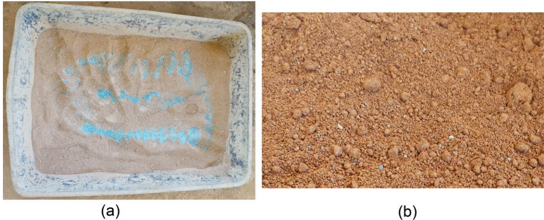
Figura 4-29 – Execução da mistura de solo, cimento e máscara descartável (a) Mistura seca e homogeneizada de solo, cimento, cal hidratada e fragmentos reutilizados de máscaras descartáveis de polipropileno; (b) Mistura úmida e homogeneizada.
