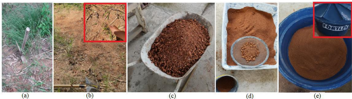
Figura 4-2 – Sequência de limpeza e estocagem dos solos (a) Limpeza do terreno; (b) Remoção da capa superficial; (c) Transporte das amostras deformadas de solo; (d) Peneiramento; (e) Estocagem em caixas d'água.
