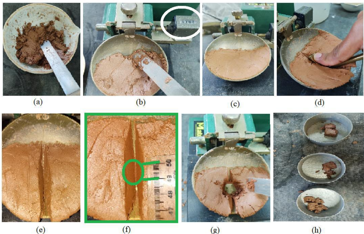
Figura 4-15 – Execução detalhada para determinação do LL.
