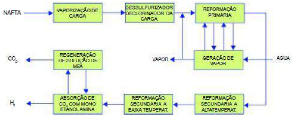
Figura B. 1: Processo esquemático de geração de hidrogênio
