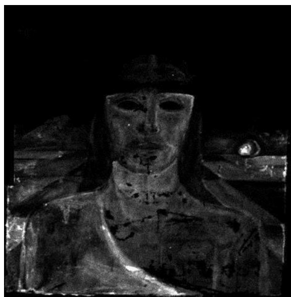
Figura 48. Mapeamento do elemento mercúrio (Hg). Fonte: acervo Lucia Helena,2022.
