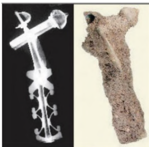
Figura 6. Broche de cruz romana feito de chumbo e bronze. A radiografia mostra a delimitação do artefato de incrustação. Fonte: HERITAGE, 2006.
