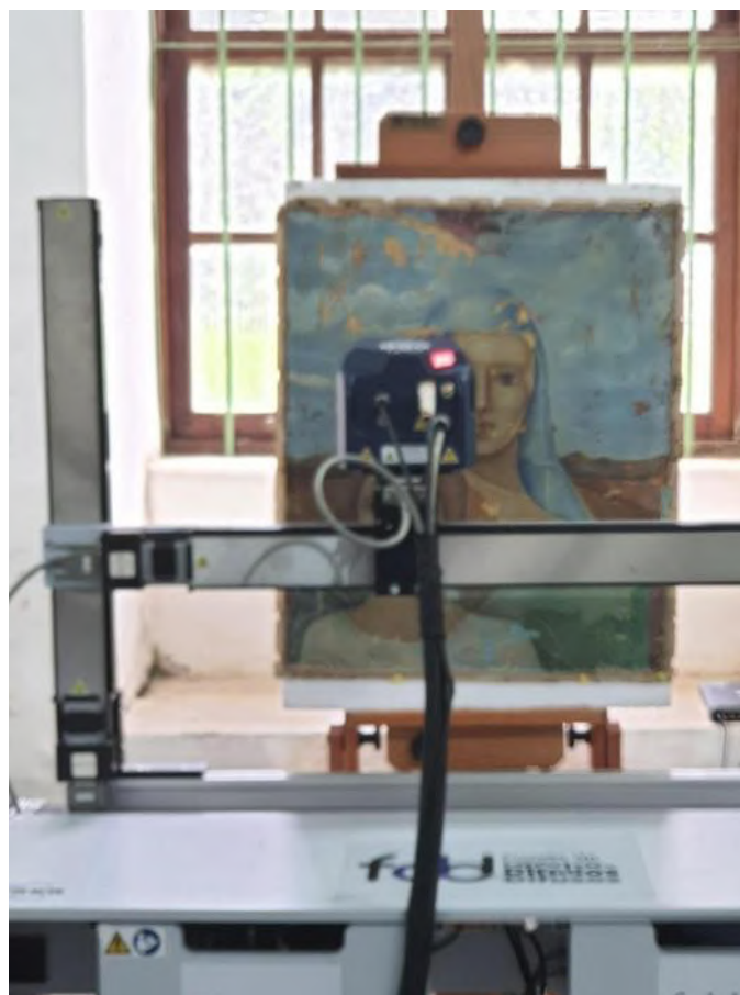
Figura 39. MA-XRF mapeando a pintura. Fonte: acervo Lucia Helena,2022.
