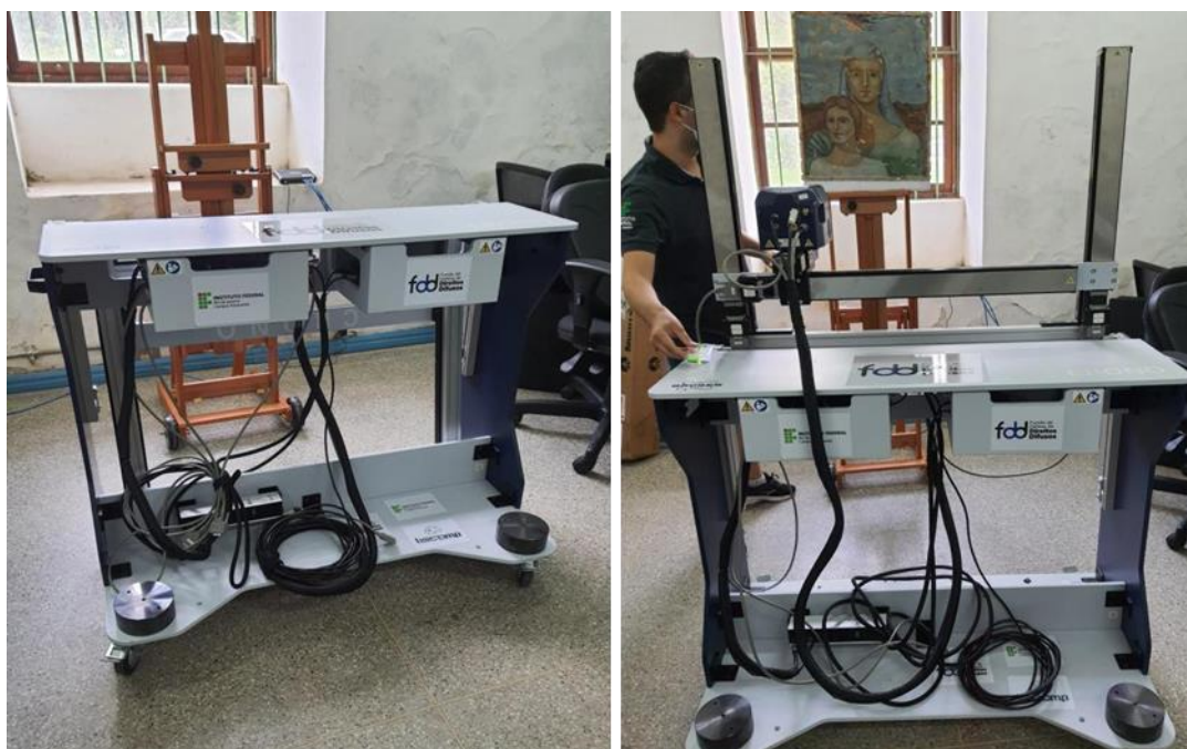
Figura 38. Equipamento portátil de MA-XRF. Fonte: acervo pessoal da autora. Na foto ao lado, a pintura sendo preparada para a análise pelo prof. Renato Freitas. Fonte: acervo Lucia Helena, 2022.
