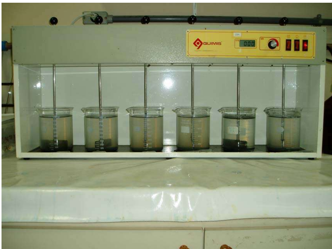
Figura III. 5 - Processo de decantação de CAP após adsorção dos compostos (EC).
