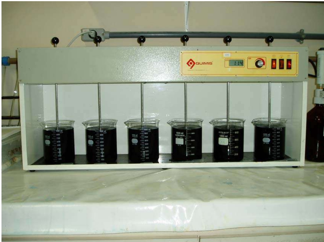
Figura III. 4 - Uso de CAP na adsorção de compostos recalcitrantes (EC).
