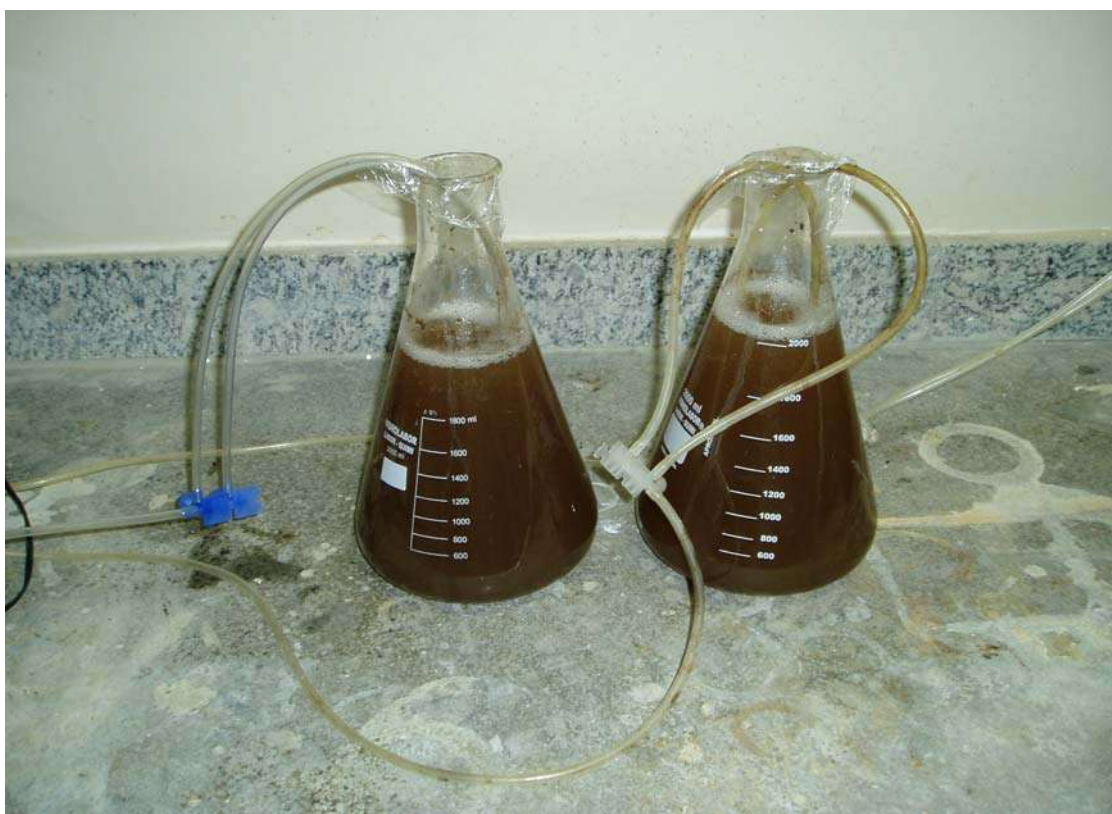
Figura III. 2 - Aeração do lodo ativado na aclimação.
